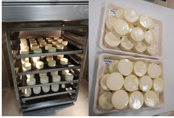
Fotoğraf 3.5. Kurutma ve 12 saat ara ile streçleme aşamaları
