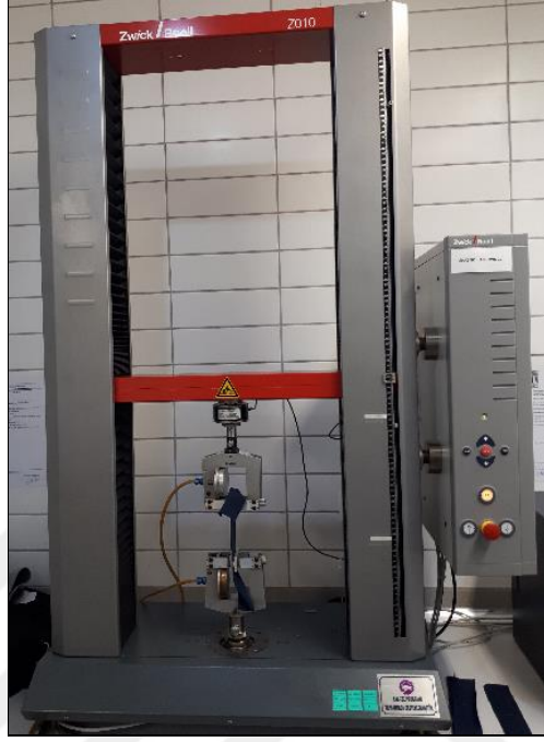
Şekil 3.23. Zwick Roell Z010 test cihazı ve testin uygulanışı
