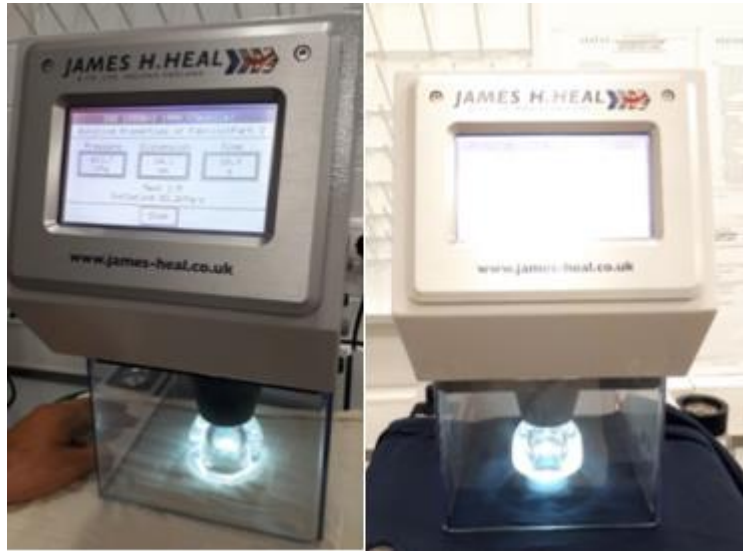
Şekil 3.20. Patlama mukavemeti test cihazı ve testin uygulanışı
