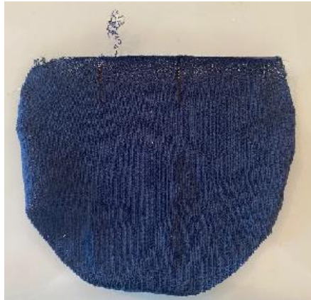
Şekil 3.14. İlmek iplik uzunluğu testinin uygulanışı
