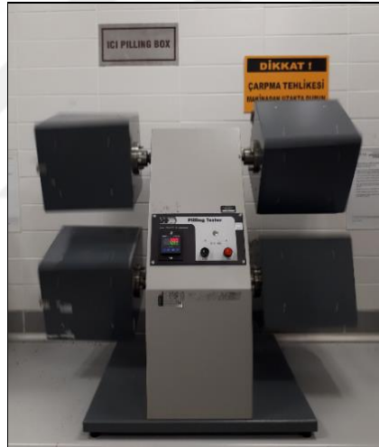
Şekil 3.25. James H. Heal ICI boncuklanma test cihazı ve testin uygulandığı kutu
