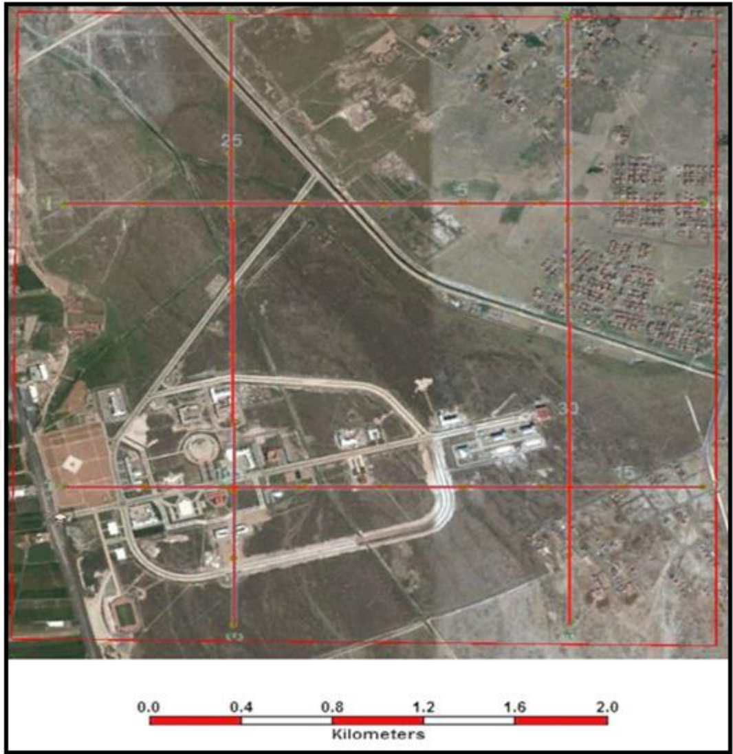
Şekil 6.3: 15 cm yer örnekleme aralığı için uçuş planlaması (Cankurt, 2016).
