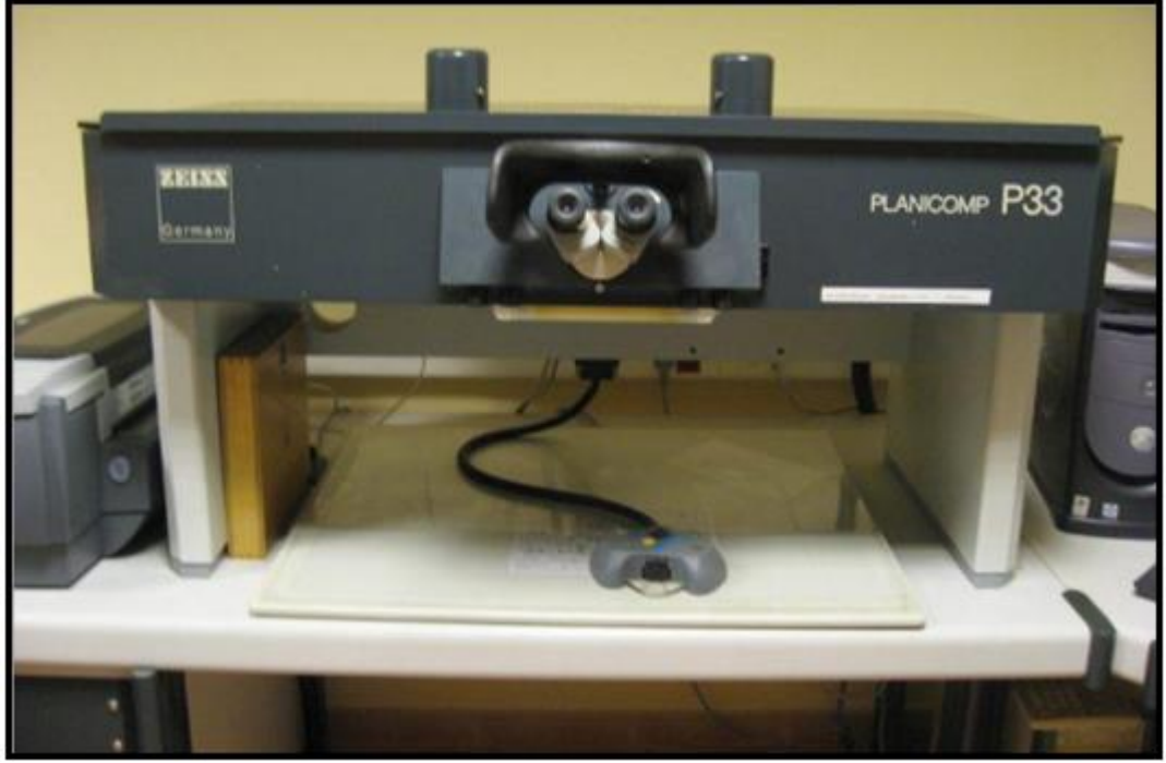
Şekil 3.4: Analitik deęerlendirme aleti “Zeiss Planicomp P33” (URL-2).
