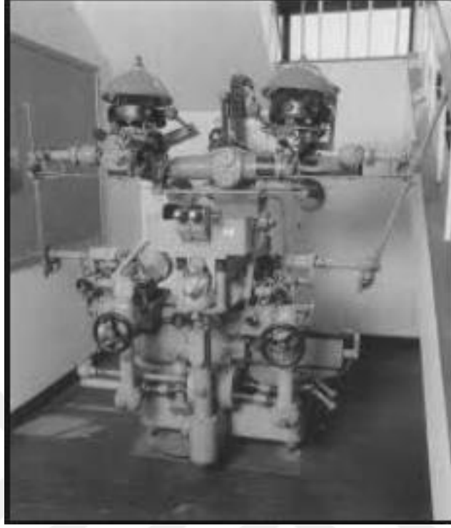
Şekil 3.3: Mekanik değerlendirme aleti “ Stereoautograph Wild A8” (Burnside, 1993).
