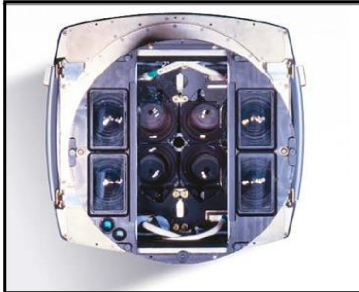
Şekil 4.4: Intergraph DMC sayısal hava kamerasının mercek sistemi (URL-3).
