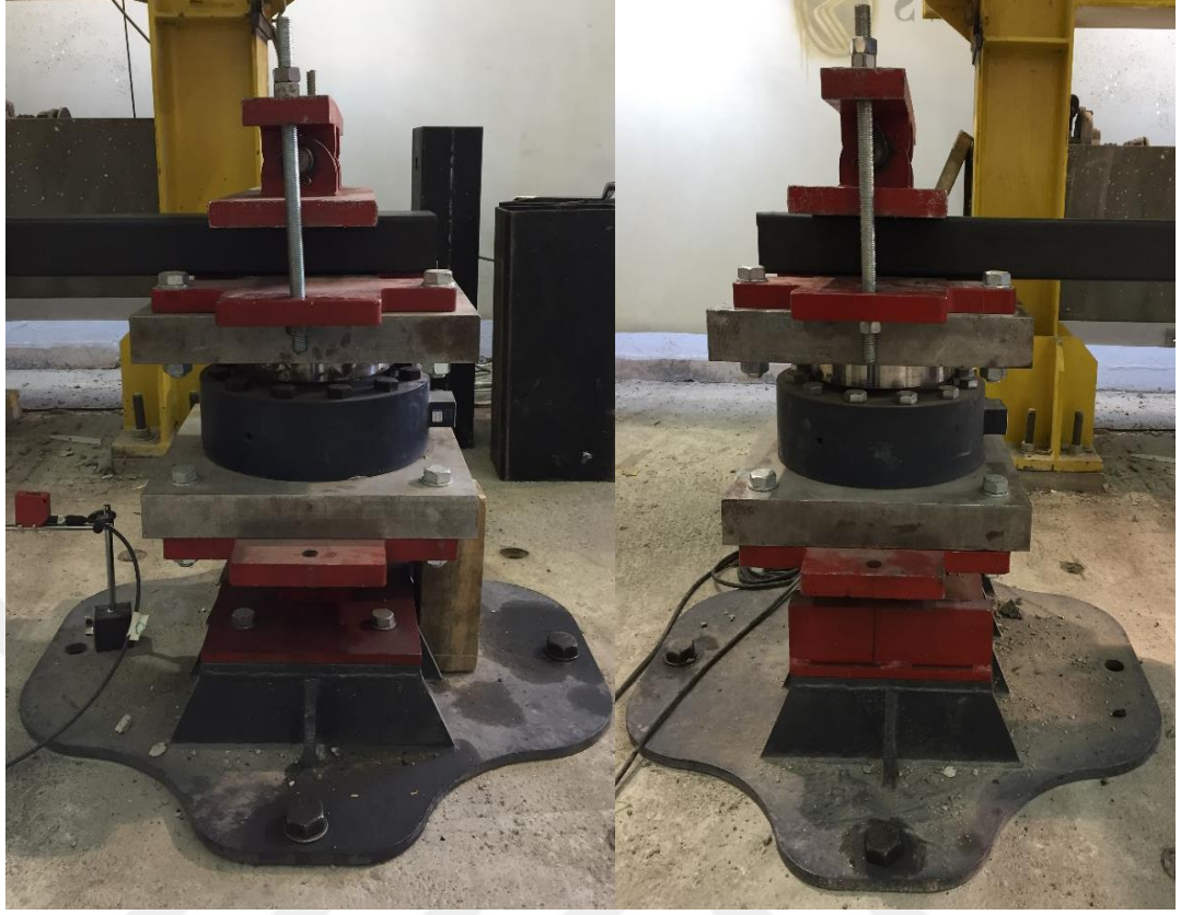
Şekil 3.13. Sabit ve hareketli mesnet
