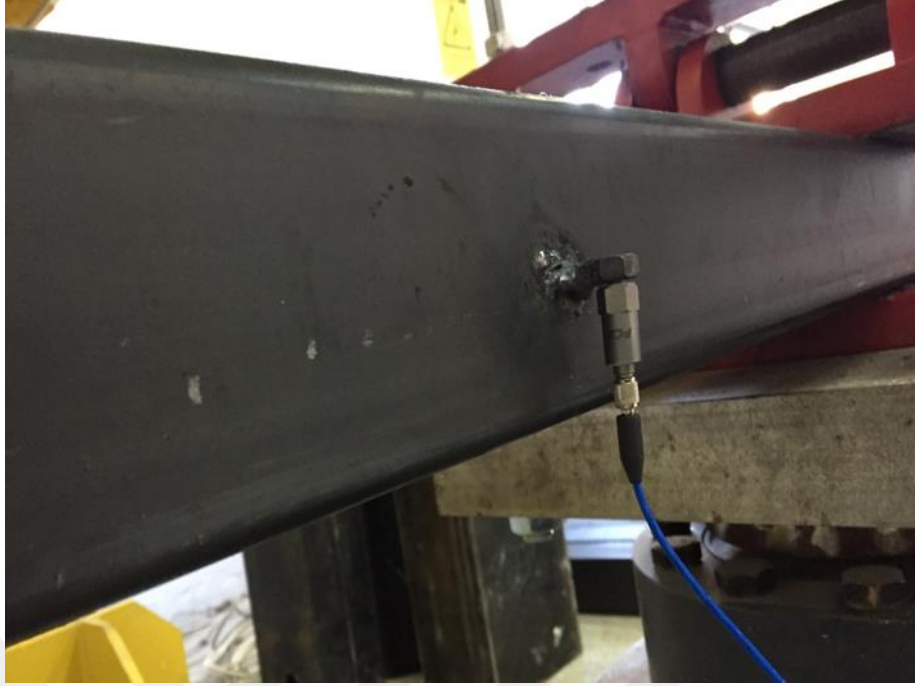
Şekil 3.16. Deney düzeneğindeki numunede bulunan ivmeölçer
