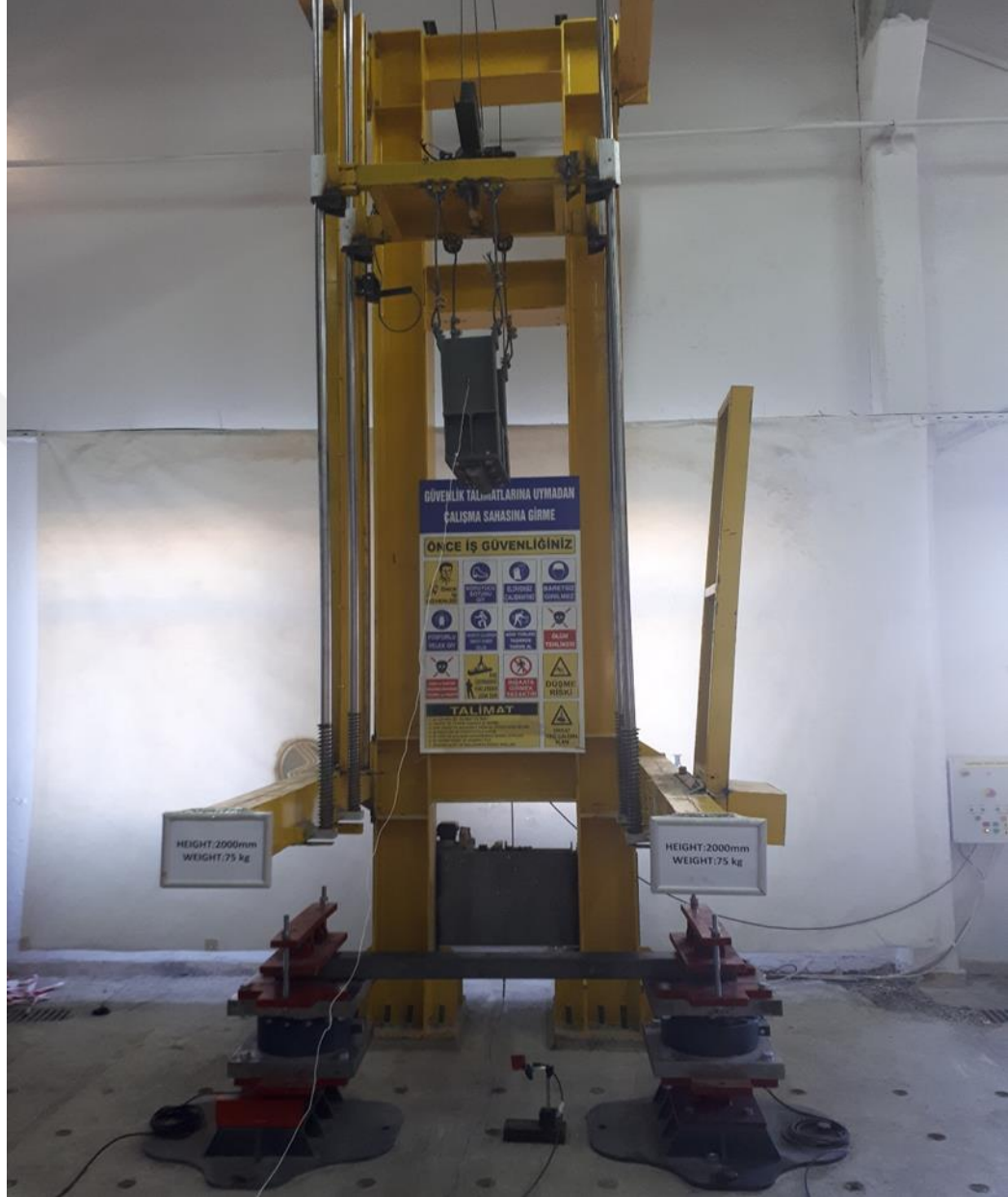
Şekil 4.8. 2000 mm yükseklikten uygulanan darbe deneyi düzeneği
