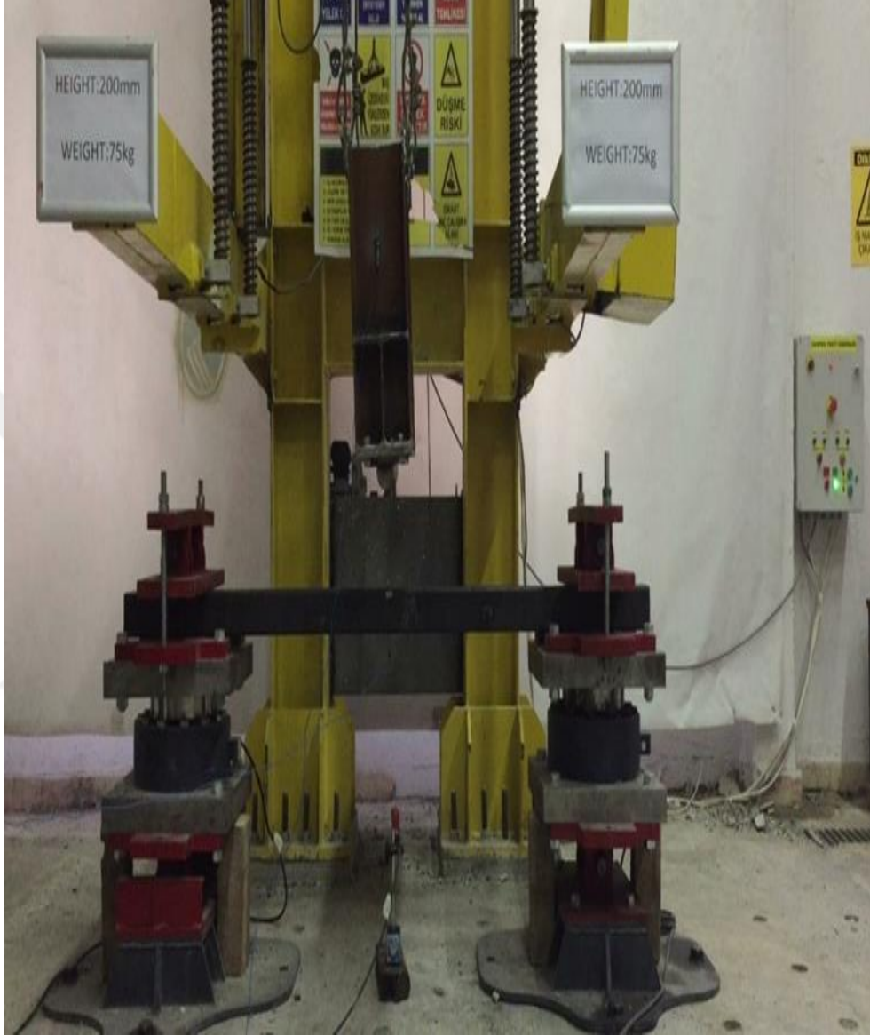
Şekil 4.1. 200 mm yüksekliğe ait darbe deneyi düzeneği
