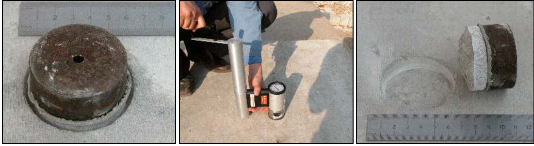
Resim 3.6. Doğrudan çekme dayanımı deneyi yapılışı
