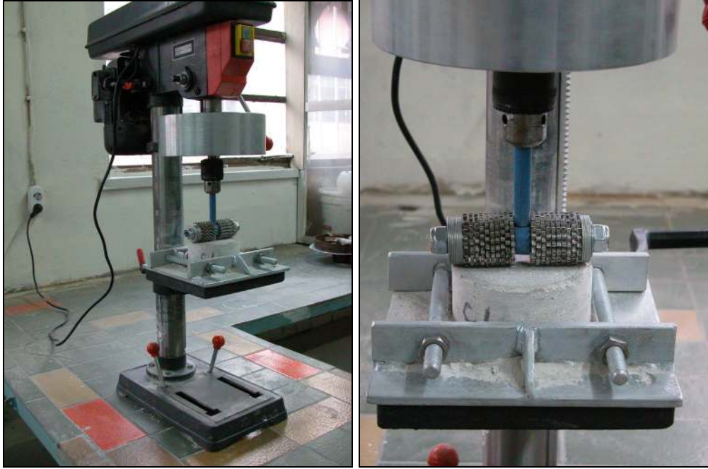
Resim 3.10. Aşınma dayanımı deney cihazı ve aşındırma aparatı
