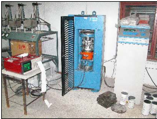
Resim 3.7. Deformasyon kontrollü beton basınç dayanımı deneyi
