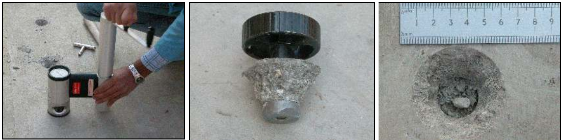
Resim 3.5. Beton bloklar üzerinde yüzeyde kopma dayanımı deneyinin yapılışı
