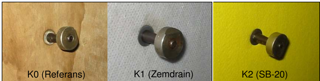
Resim 3.4. Kalıp yüzeylerine yerleştirilen diskler
