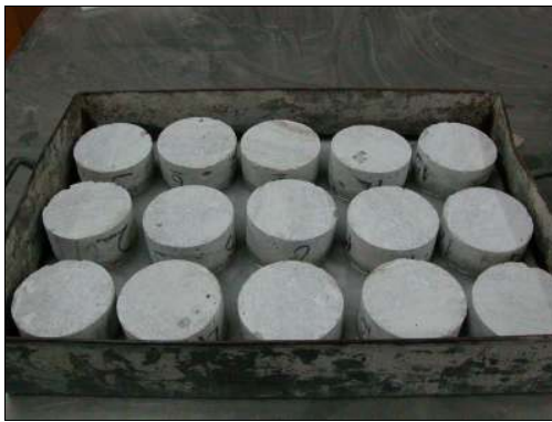
Resim 3.9. Kapiler su emme deneyi
