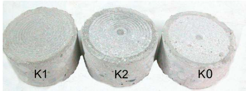
Resim 4.1. Aşınma deneyinden sonraki beton numunelerinin görüntüsü
