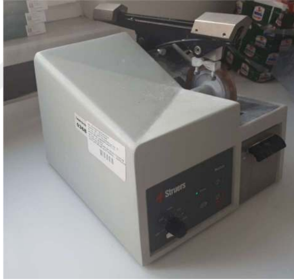
Resim 6. Minitom (Hassas kesme cihazı) ile örneklerin kesilmesi
