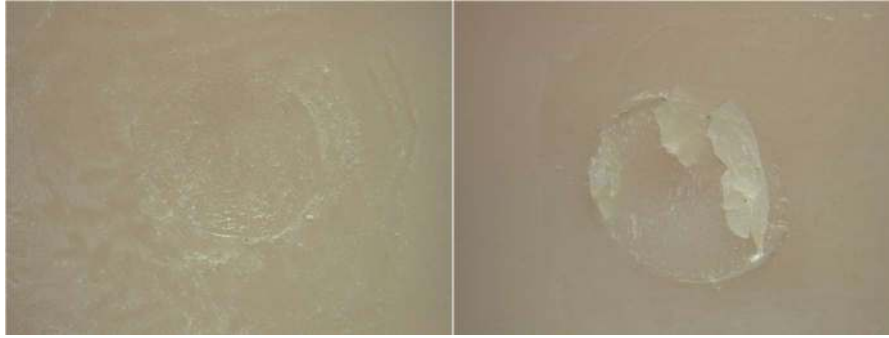
Resim 32. Lava Ultimate- Kumlama grubu stereomikroskop görüntüleri
