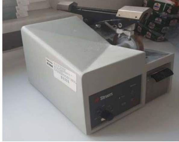
Resim 9. Minitom (Hassas kesme cihazı) ile örneklerin kesilmesi
