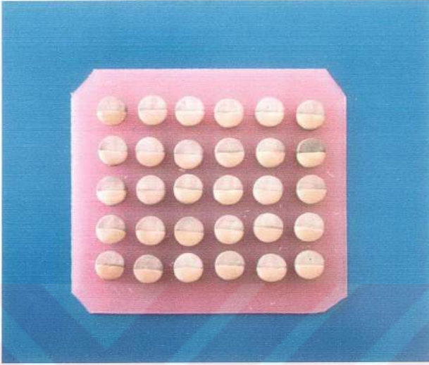
Resim 12: Üçüncü Grubu Oluşturan Metal+Porselen Örnekler
