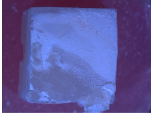
Şekil 4.4. Seramikte koheziv tipte kırığın seramik yüzey görüntüsü
