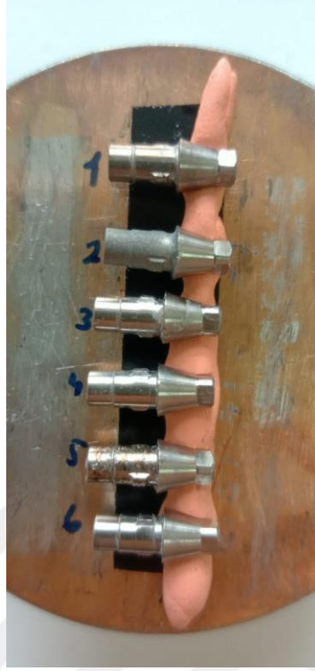
Şekil 3.25. Ti-base abutmentların plakaya sabitlenmesi
