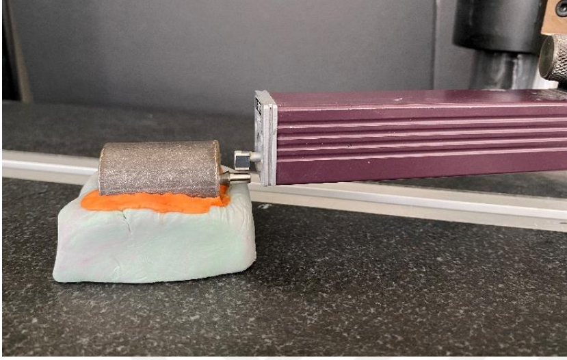
Resim 3.13. Hazırlanan matrikste profilometre ile abutment yüzey pürüzlülüğü ölçümü
