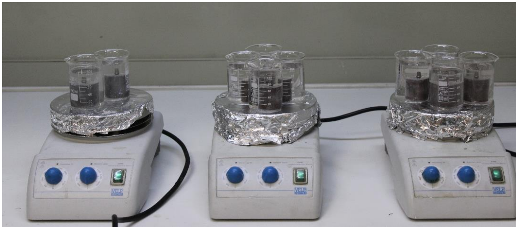
Resim 3.7. Abutmentlere asit uygulanması
