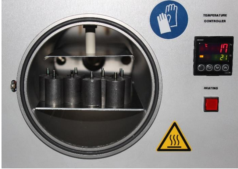
Resim 3.10. Abutmentlerin kuvartz bölmesine yerleştirilmesi
