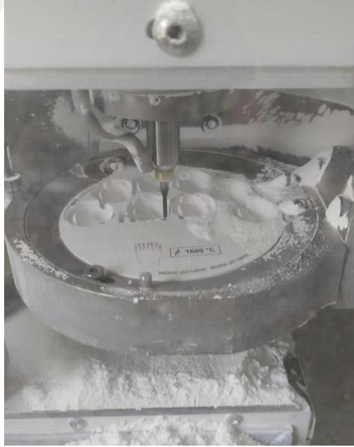
Şekil 3.3. Örneklerin CAD/CAM cihazında hazırlanması
