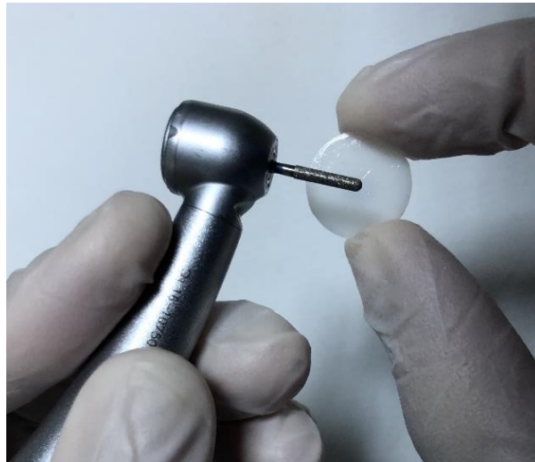
Şekil 3.9. Örnekler aşındırma işlemi uygulanması
