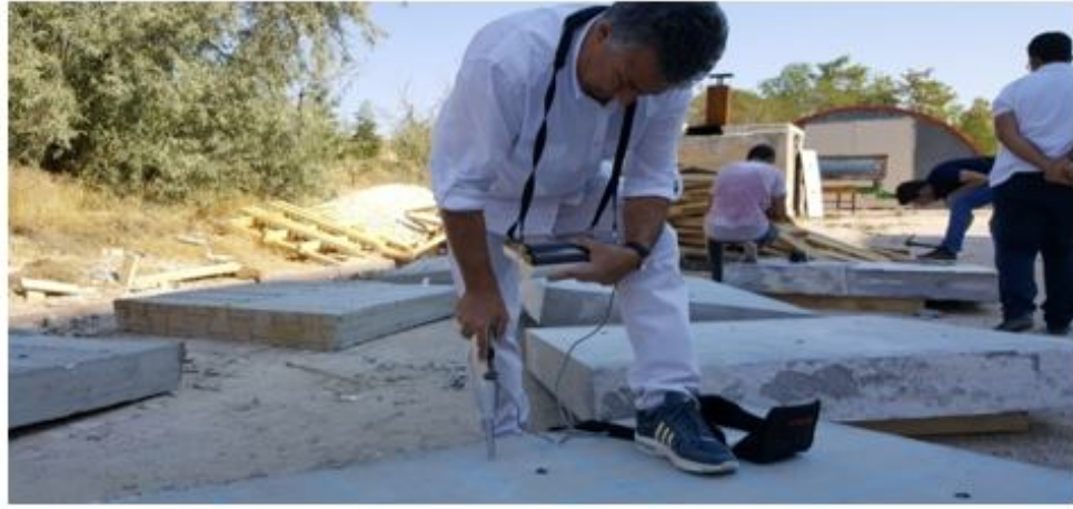
Şekil 4. 1. Schmitd çekici testi uygulaması.
