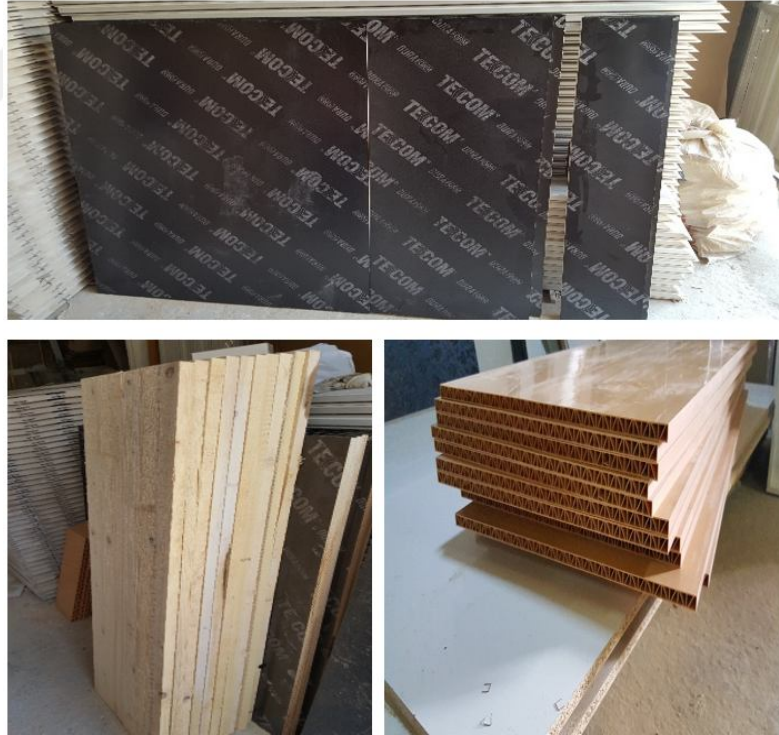
Şekil 3. 3. Kesilen çam kereste, plywood ve plastik kalıp yüzeyleri
