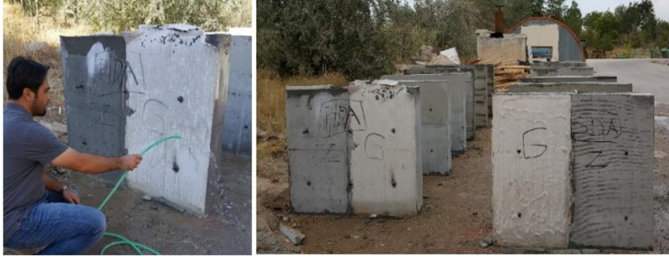
Şekil 3. 30. Beton kür uygulaması
