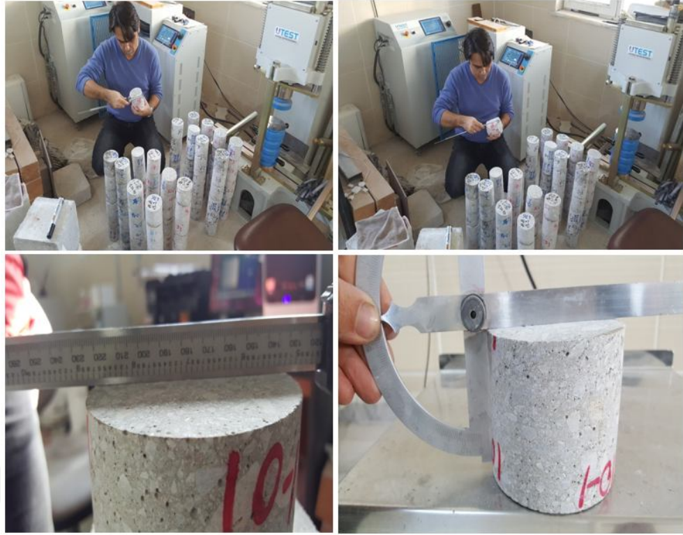
Şekil 4. 4. Karot numunelerinin ölçümlerinin yapılma işlemi
