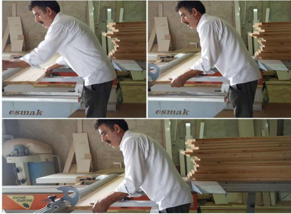
Şekil 3. 2. Kalıp yüzeylerinin hazırlanma işlemi
