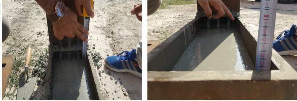
Şekil 3. 22. L kutusu deneyi uygulama anı
