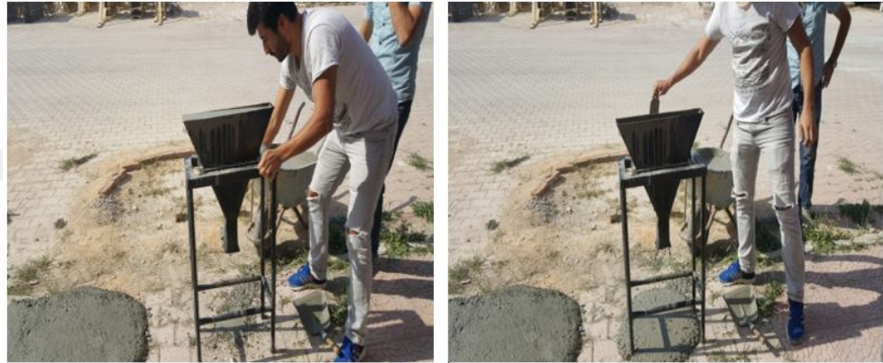
Şekil 3.20. V hunisi deneyi uygulama anı
