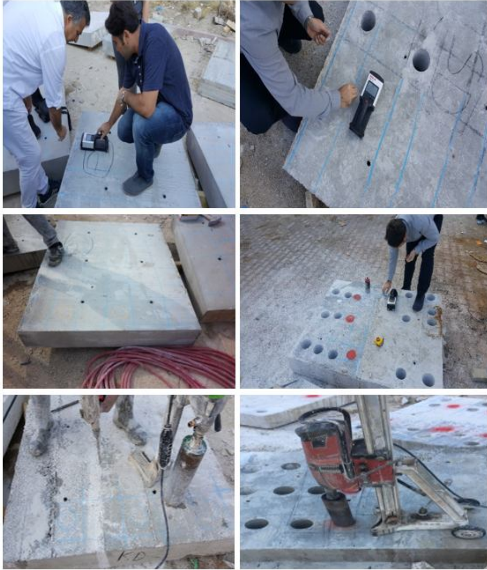
Şekil 4. 2. Beton bloklardan karot alma aşamaları
