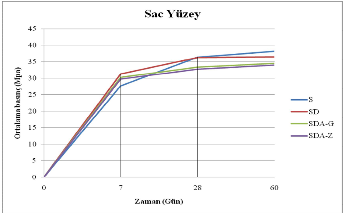
Şekil 4. 7. Sac kalıp basınç mukavemetleri değişim grafiği
