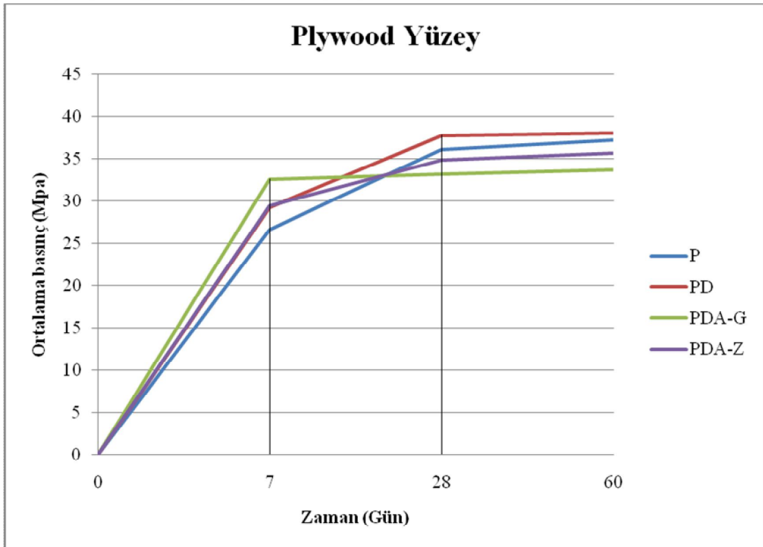
Şekil 4. 8. Plywood kalıp basınç mukavemetleri değişim grafiği
