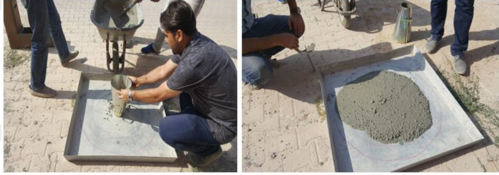
Şekil 3.18. Çökme-Yayılmı deneyi uygulama anı
