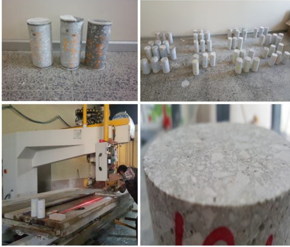
Şekil 4. 3. Alınan karot numunelerinin hazırlanma aşamaları
