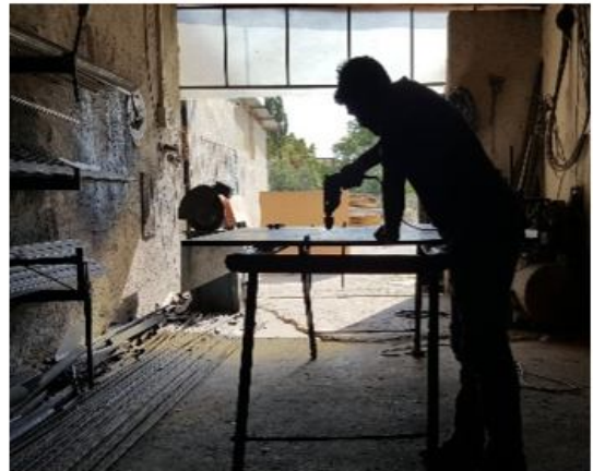
Şekil 3. 5. 2 mm drenaj deliği açma işlemi
