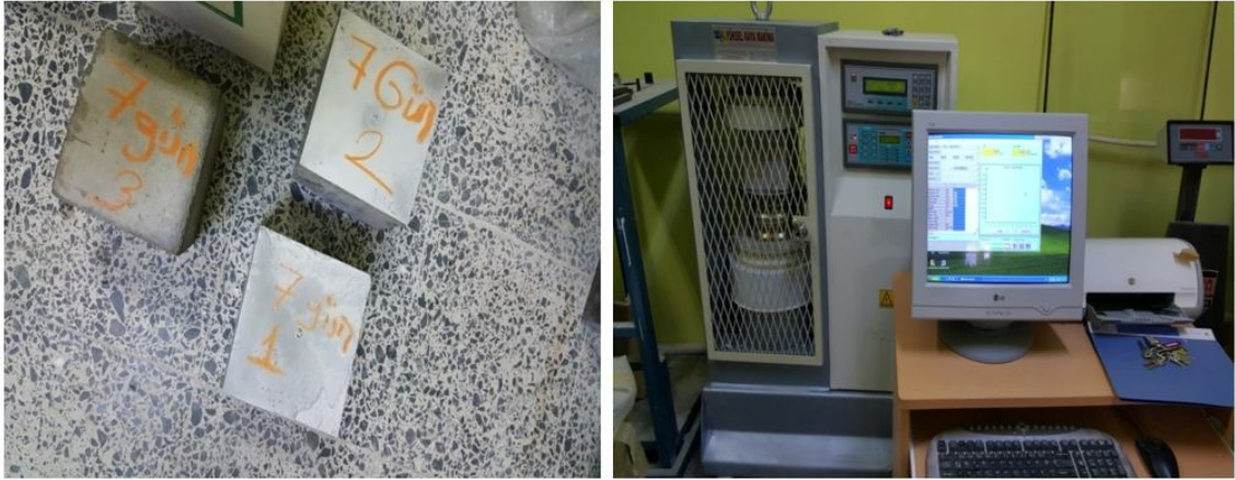
Şekil 4. 11. Küp numunelerin kırım anı
