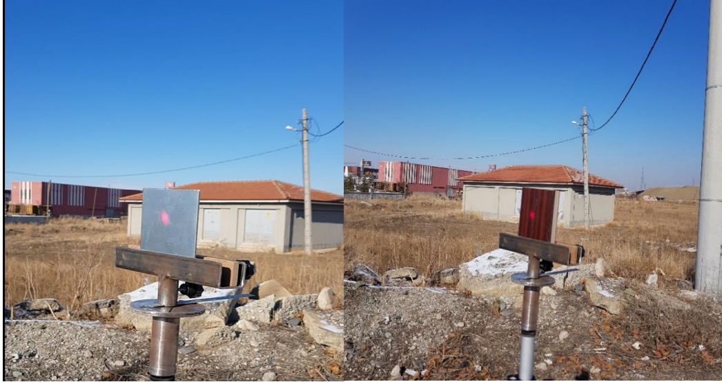
Şekil 3. 12: Hedefler üzerine yönlendirin ölçü aletinden çıkan lazer ışınının gösterimi
