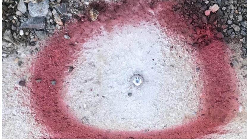
Şekil 3. 9: Ölçmelerin yapıldığı mesafeler için tesis edilen ve işaretlenen çivi
