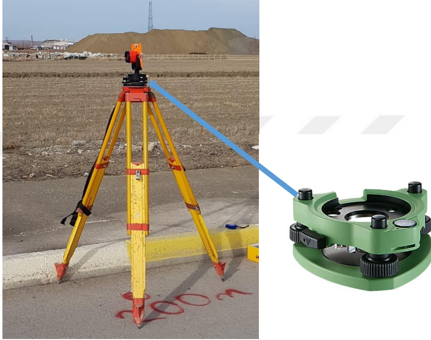
Şekil 3. 8: Tripot ve üzerine yerleştirilen tribrah
