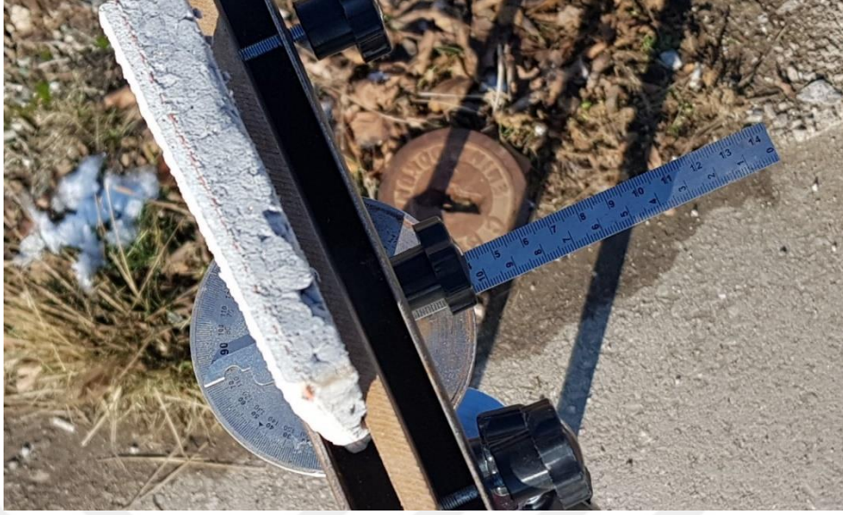
Şekil 3. 11: Hedef yerleşme aparatı üzerindeki açölçer daire
