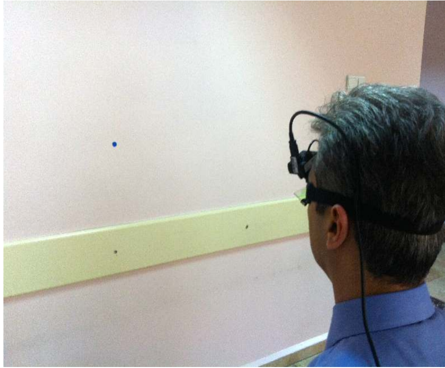
Şekil 3.2. Gözlük yerleştirilen gönüllü (hasta) ve duvarda önceden belirlenmiş mavi nokta şeklindeki bakış hedefinin görüntüsü.
