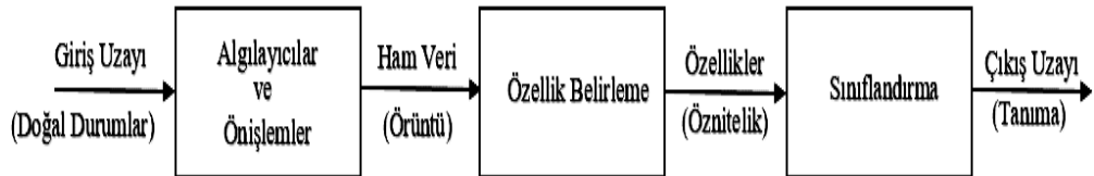
Şekil 3.2. Örüntü tanıma sistemi blok diyagramı.
