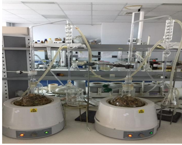
Görsel 3.6. Salvia sclarea 'nın toprak üstü kısımlarından uçucu yağ eldesi
