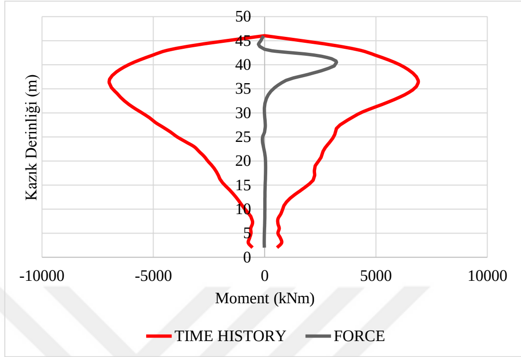
Şekil 4.23. DD1 deprem düzeyi için momentler yönünden TH ve Deplasman yöntemlerinin karşılaştırılması.
