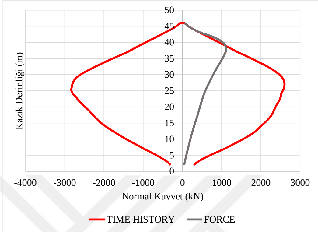
Şekil 4.25. DD1 deprem düzeyi için normal kuvvet yönünden TH ve Deplasman yöntemlerinin karşılaştırılması.
