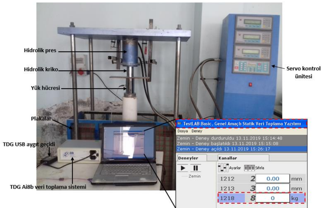
Şekil 3.12. Yüklemenin uygulanmasını ve izlenmesini sağlayan sistem
