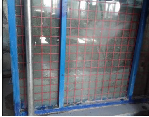
Şekil 3.27. Gevşek kumun suya doygun hale getirilmesi
