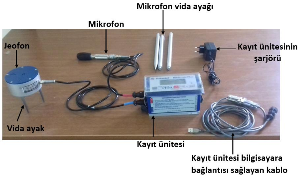
Şekil 3.17. Instantel Minimate Plus'ın elemanları
