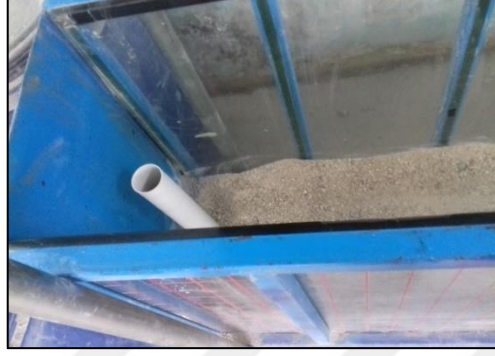
Şekil 3.8. Yerealtından kaynaklanan titreşim dalgalarını modellemek için kullanılan PVC borunun yerleştirilmesi
