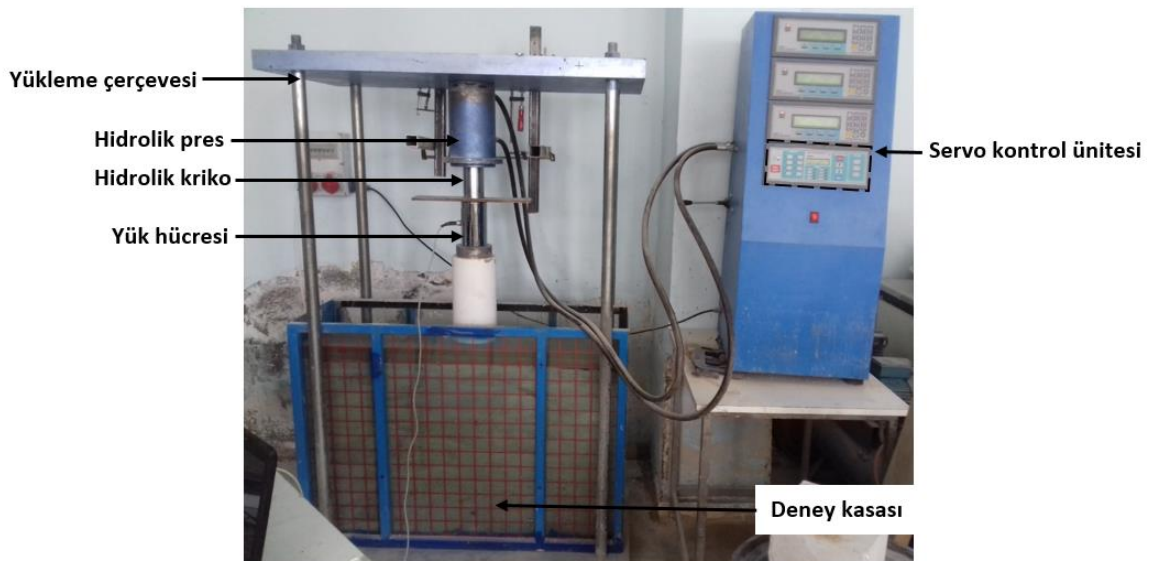
Şekil 3.9. Düşey yük uygulamasında kullanılan hidrolik pres ve yükleme çerçevesi
