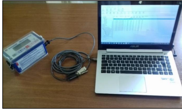
Şekil 3.32. Sismograf tarafından kayıt edilen titreşim değerlerinin bilgisayara aktarımı
