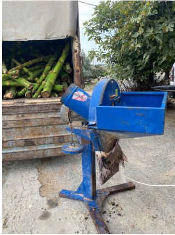
Şekil 3.2. Muz yalancı gövdelerini parçalamada kullanılan ekipman
