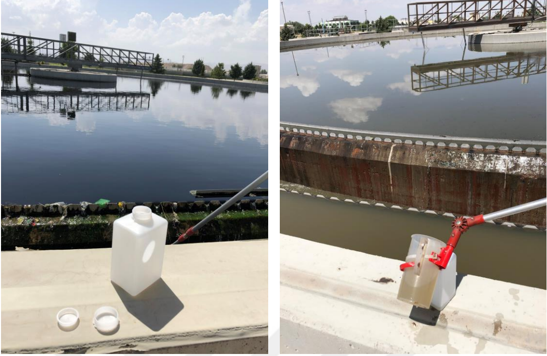
Şekil 3.4. Konya AAT'nin atıksu hattından numune alımları
