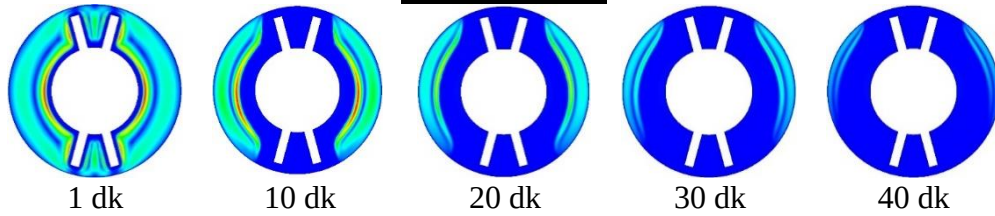
Şekil 5.15. Model 5 katılaşma analizi için zamana bağlı sıvı fraksiyonu, sıcaklık ve hız konturları a) \alpha=30^\circ , b) \alpha=45^\circ , c) \alpha=60^\circ
