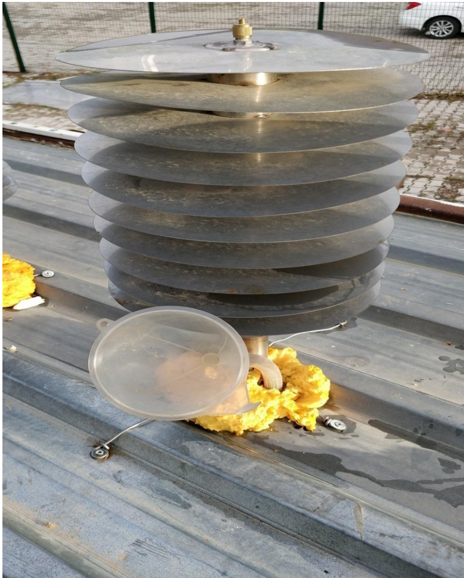
Şekil 2.25. Eritilip sıvı hale getirilmiş faz değıştiren malzemenin ısıl enerji deposuna doldurulma noktası
