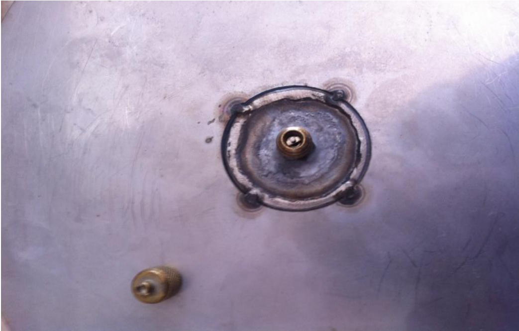
Şekil 2.9. Isı borusunun soğutucu gaz giriş valfi
