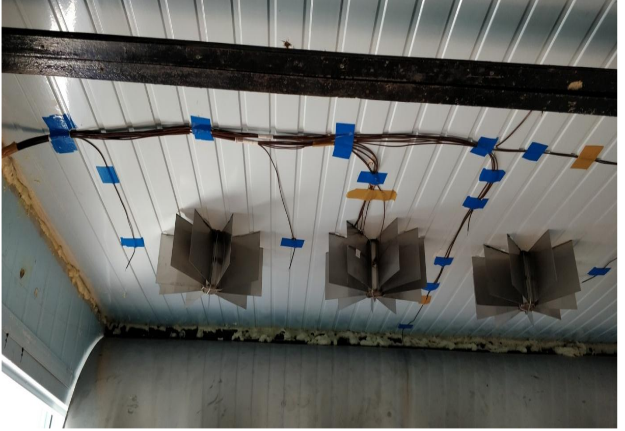
Şekil 2.15. Isıl enerji deposunun içine yerleştirilmiş ısı çiftlerinin başka açıdan görünümü
