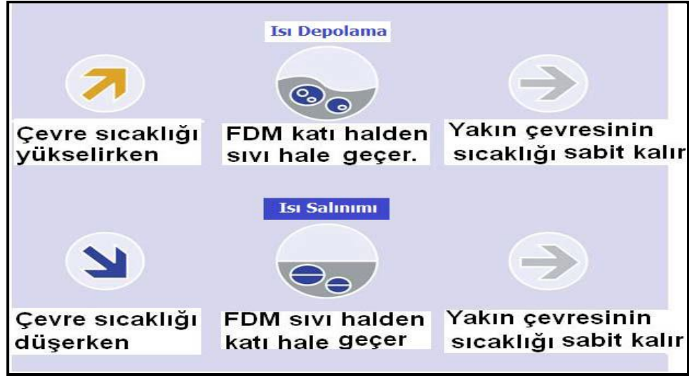
Şekil 2. 4 FDM'lerin ısıyı depolama ve yayma prensipleri
