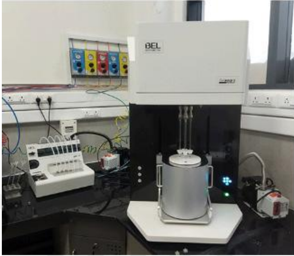
Şekil 2.6. Brunauer, Emmett ve Teller (BET) analizi
