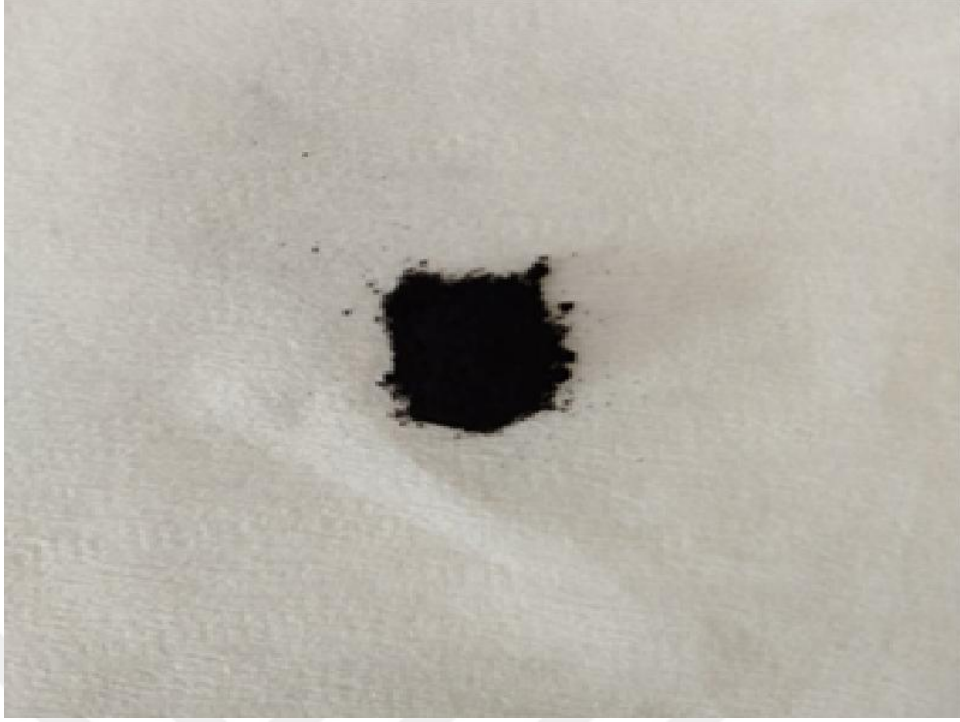
Şekil 2.9. Sızdırmazlık testi sonuçları: Başlangıç durumu
