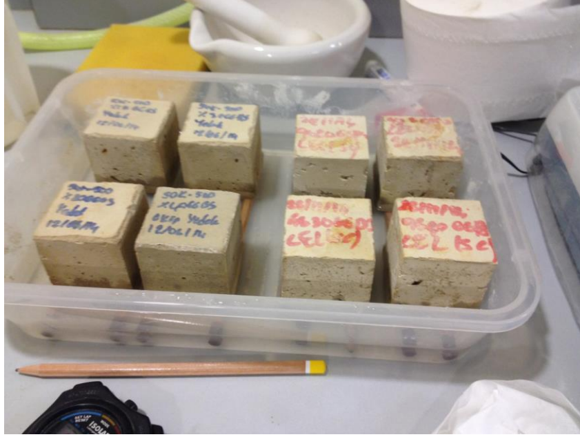
Şekil 3.10 Kılcal su emme deneyi
