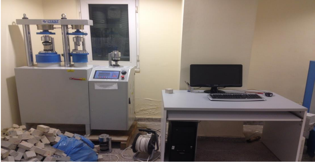
Şekil 3.11 Basınç ve eğilme dayanımı cihazı
