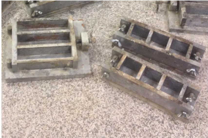
Şekil 3.7 Kiriş ve küp numune kalıpları
