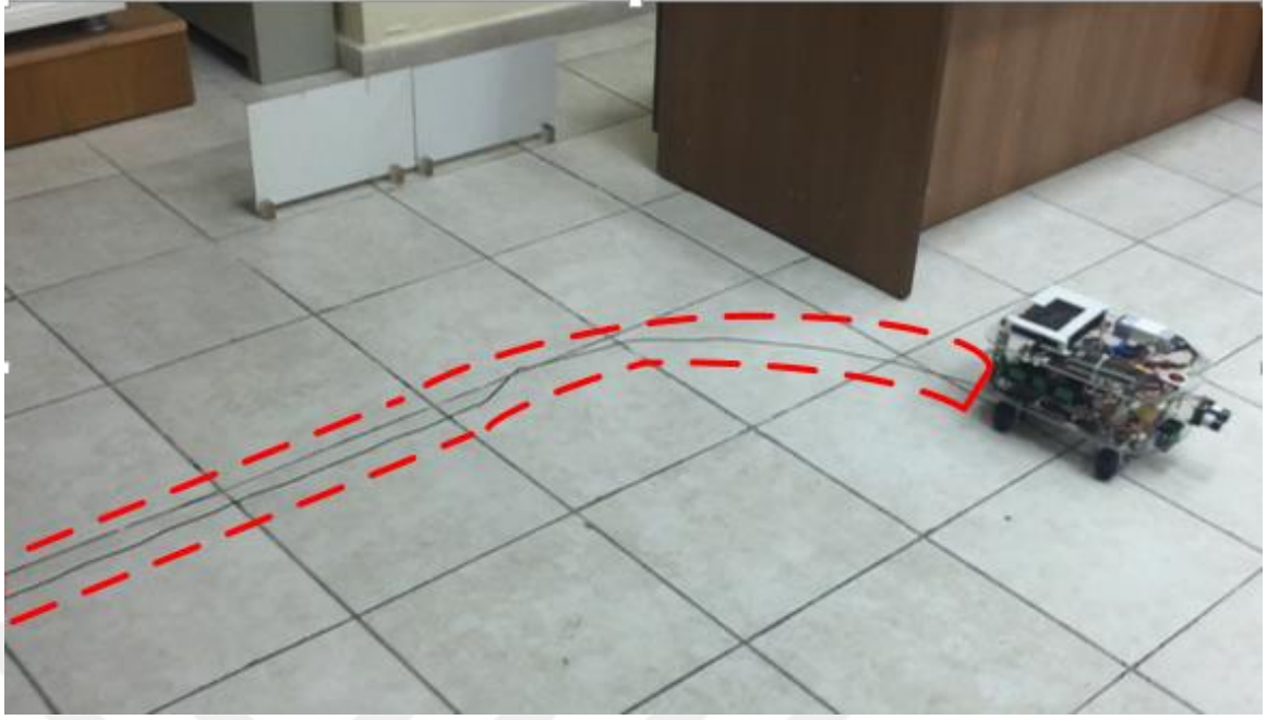
Şekil 5.25. Mobil Robotun Ön Taraftaki ve Sol Taraftaki Engeli Algılayarak Sağa Doğru Yön Değiştirmesini İçeren Yörüngesi
