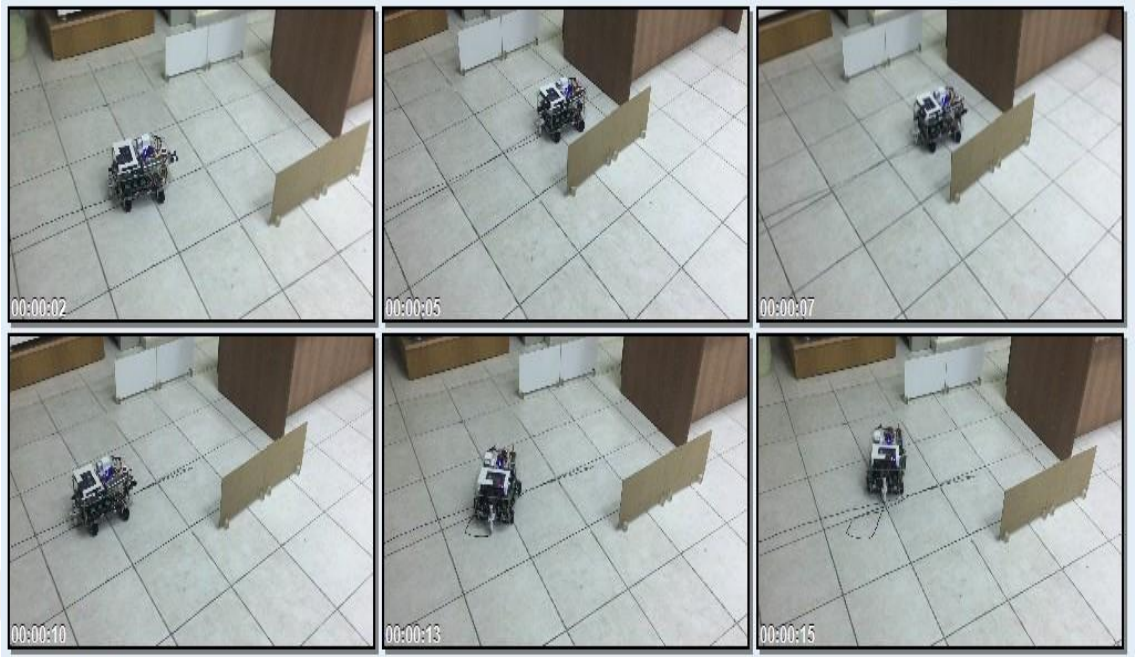
Şekil 5.26. Mobil Robotun Ön Taraftaki, Sol Taraftaki ve Sağ Taraftaki Engeli Algılayarak Geri Yönde İlerlemesi ve Sola Doğru Yön Değiştirmesi
