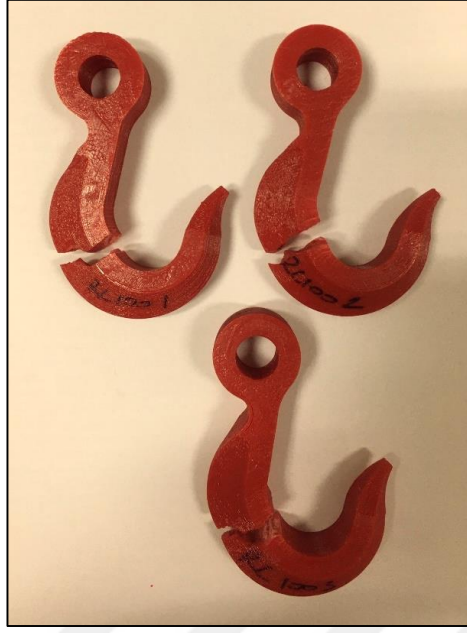
Şekil 4.16. Çekme testi yapılan %100 dolu kanca numunesi.
