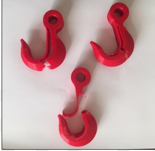
Şekil 4.24. Honeycomb dolgu deseni ile %20 dolulukta üretilip çekme testi yapılmış numuneler.
