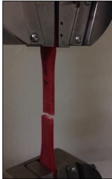
Şekil 4.4. Çekme testi yapılan numune.
