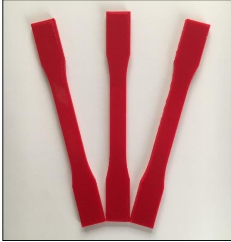
Şekil 4.3. % 100 dolu olarak üretilen çekme test parçası.
