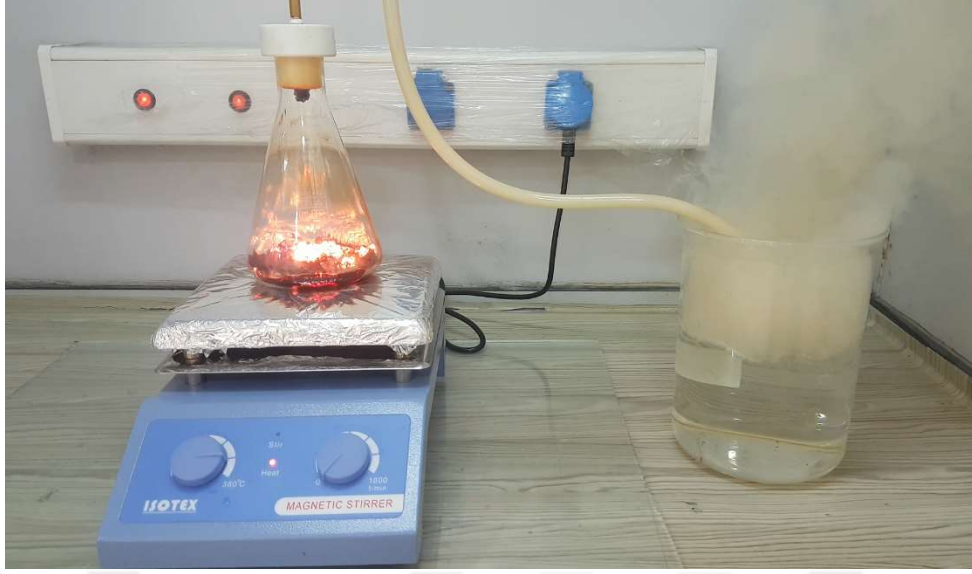
Şekil 2.4. Fe 3 O 4 nanoparçacıklarının üretimi esnasında gerçekleşen yanma
