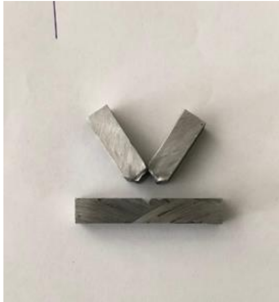
Şekil 4.9 Charpy Çentik Deney Sonunda Kırılan Numune Örneği
