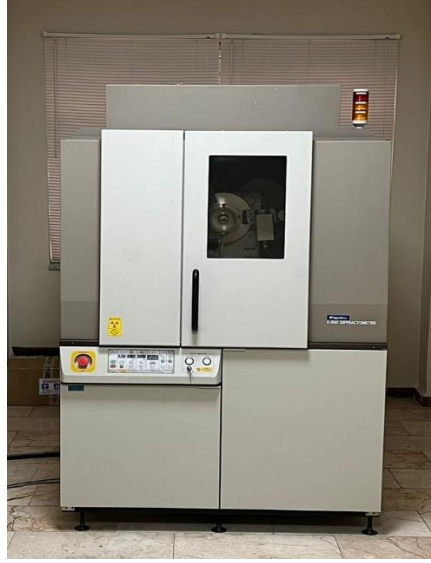
Şekil 3.3. Sakarya Üniversitesi Mühendislik Fakültesi Metalurji ve Malzeme Mühendisliği Bölümü'nde bulunan Rigaku D-Max 2100 PC Model Difraktometre Cihazı.
