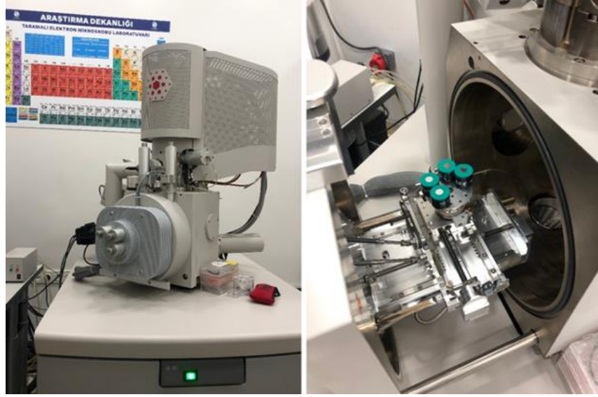
Şekil 3.4. Sakarya Üniversitesi Araştırma Dekanlığı Araştırma-Geliştirme Uygulama ve Araştırma Merkezi (SARGEM)’nde bulunan Quanta FEG-450 Model FEG-SEM cihazı.
