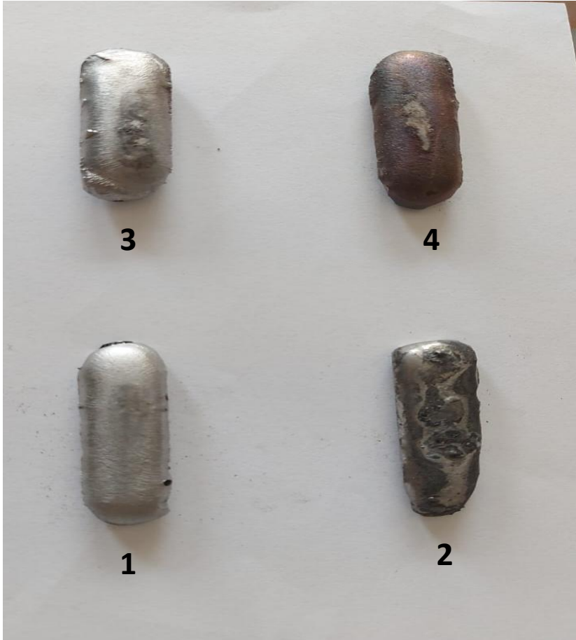
Şekil 2.7. Üretilen numuneler (1.numune \text{Fe}_{85}\text{Si}_7\text{B}_8 , 2.numune \text{Fe}_{75}\text{Si}_7\text{B}_8\text{Ni}_{10} , 3.numune \text{Fe}_{75}\text{Si}_7\text{B}_8\text{Co}_{10} , 4.numune \text{Fe}_{75}\text{Si}_7\text{B}_8\text{Cr}_{10} )
