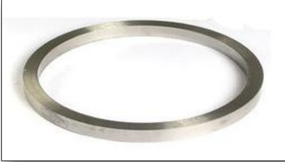
Şekil 1.2. Fe-Si-B alaşımlı şerit trafo çekirdek malzemesi
