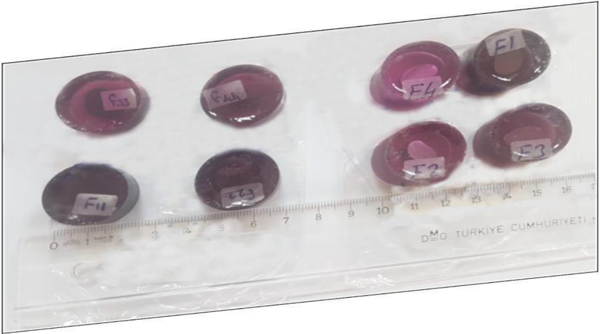
Şekil 2.11. Metalografik çalışma için hazır hale getirilen bakalite alınmış numeneler
