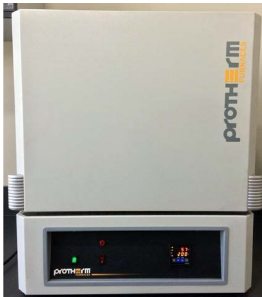
Şekil 3.2. Isıtma işlem ve çevrimsel oksidasyon deneylerinde kullanılan kamara fırını
