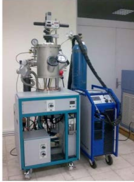
Şekil 3.1. Numune üretimi için kullanılan Edmund Bühler AM500 ark ergitme ünitesi.
