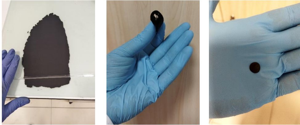
Şekil 3.5. Esnek ve serbest duran kâğıt formundaki aktif karbon elektrot.
