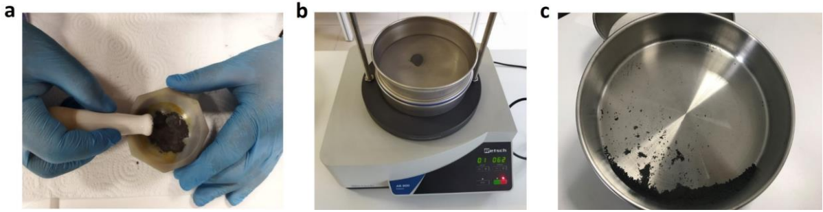
Şekil 3.3. Sinterlenmiş MAB peletlerinin öğütülmesi ve eleme işlemlerine ait görseller: (a) havanda parçalama, (b) eleme işlemi, (c) elde edilen ince toz.
