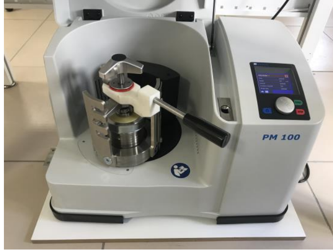
Şekil 3.2. Toz karışımlarının homojenleştirilmesi amacıyla kullanılan bilyalı öğütme sistemi.
