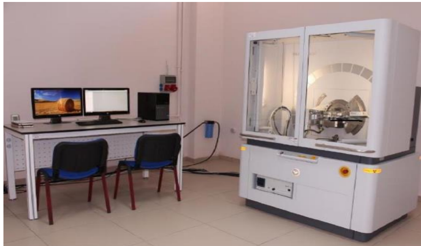
Şekil 4.4. Panalytical Empyrean X-Işınları kırınımı cihazı
