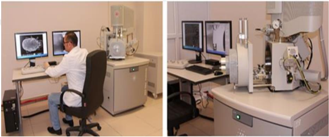
Şekil 4.7. EDAX dedektörüne sahip taramalı elektron mikroskobu (FESEM)
