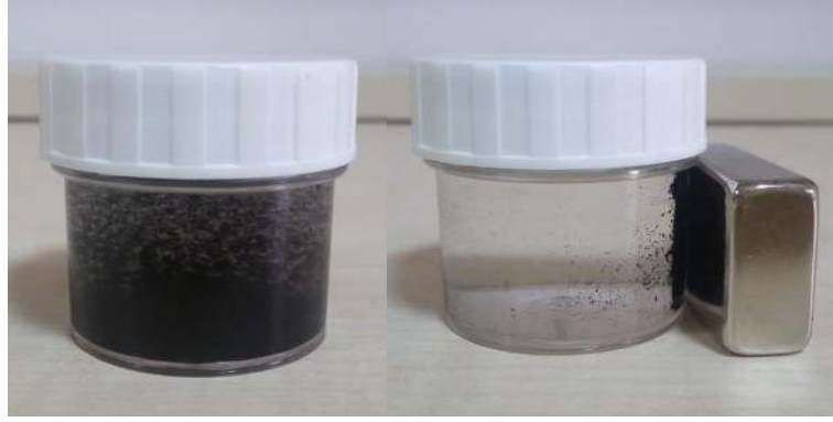
Şekil 5.5. Antibiyotik çözeltilerinden \text{Fe}_3\text{O}_4 -ÇDKNT'lerin neodyum mıknatısı ile ayrılması
