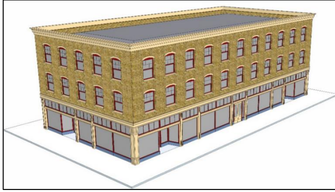
Şekil 3.21. Burulma plan düzensizliği olan bir bina gösterimi (FEMA P-154, 2015)
