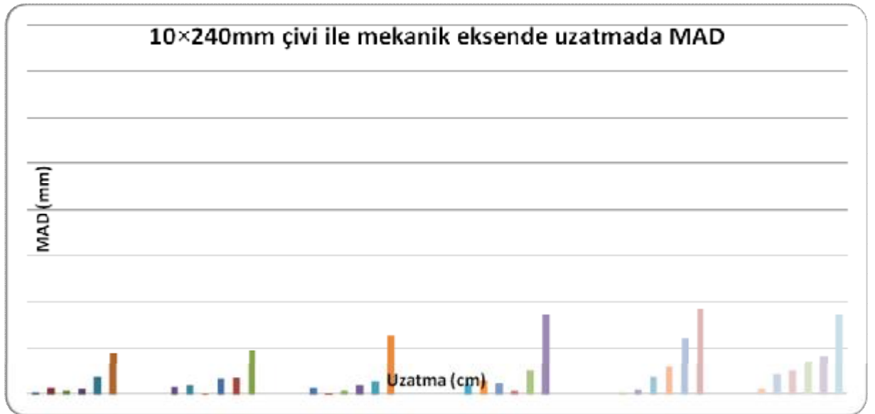
Grafik 4: 10×240mm çivi ile mekanik eksende uzatma ile mekanik aks sapması.
