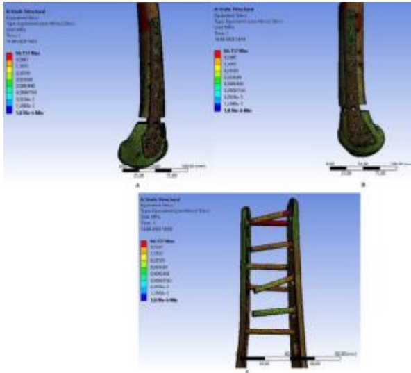
Resim 10. Grup C' deki principle stres değerleri A. Maximum, B. Minimum
