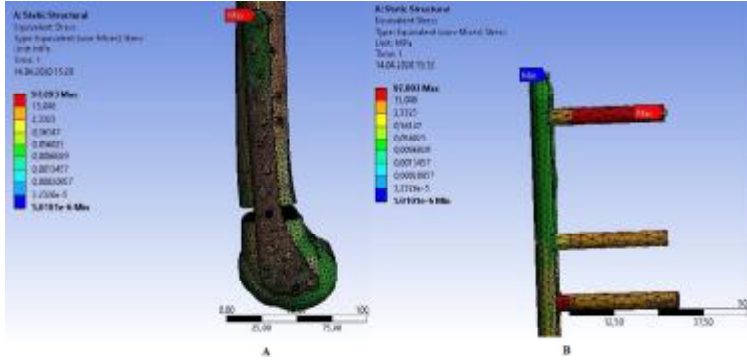
Resim 9. Grup B' deki von mises stres değerleri A. Medial plak üzerindeki, B. Lateral plak üzerindeki, C. Vidalar üzerindeki değerler
