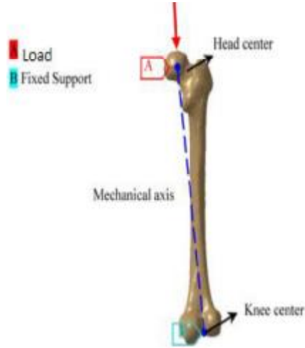
Şekil 45. FEA' da kuvvet uygulama sırasında kemiğin pozisyonu
