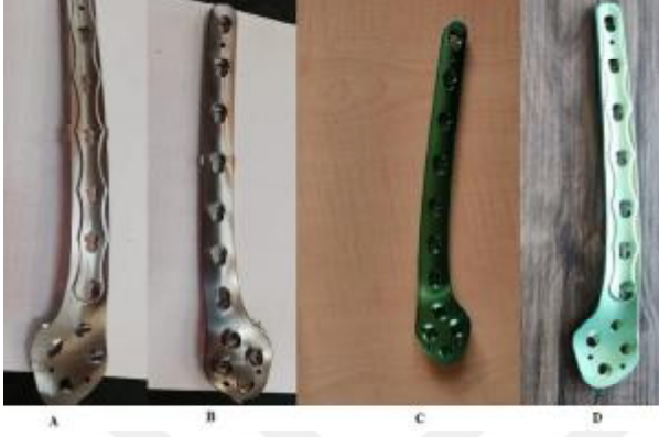
Resim 13. A. Prototip plağın arka yüzü, B. Ön yüzü, C. Yüzey işlem ve renklendirme sonrası ön yüzü, D. Arka yüzü
