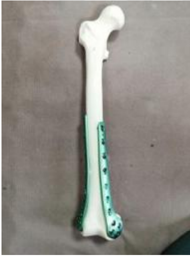
Resim 15. Lateral ve medial plağın yapay kemik üzerine fikse edilmiş pozisyonu
