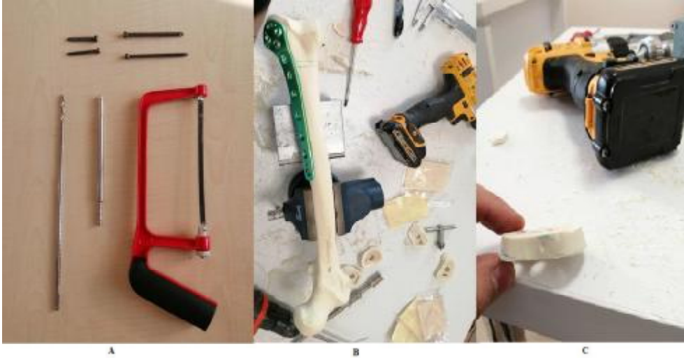
Resim 21. A. Kullanılan malzemeler, B. Yapay kemiğe plakların fiksasyonu için kullanılan sabitleme cihazları ve ek malzemeler, C. Osteotomi sonrası çıkarılan 1 cm' lik kemik bloğu
