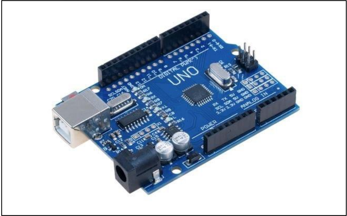
Şekil 12. Araştırmada Kullanılan Arduino Uno R3 Klon Mikro Kontrolcü Kartı (İzgöl, 2015)
