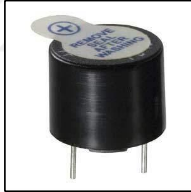
Şekil 18. Araştırmada Kullanılan 5V Buzzer (Şeremet, 2019)
