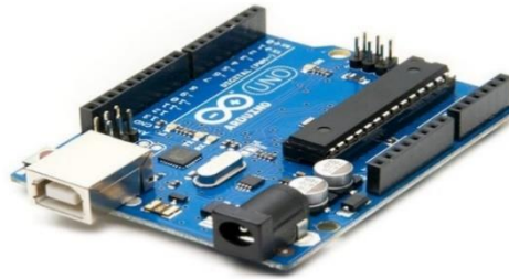
Şekil 11. Arduino Uno Robotik Kontrol Kartı
