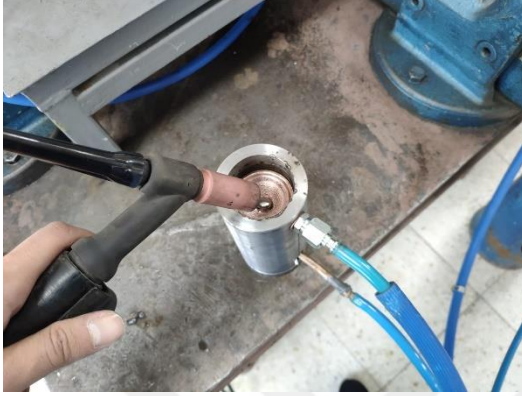
Resim 3.6 Mastır alaşımların ark ergitme yöntemiyle ters vakum döküm sistemi.
