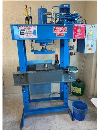
Resim 3.3 20 mm çaplı çelik kalıp ve Hidroliksan tek eksenli pres cihazı.
