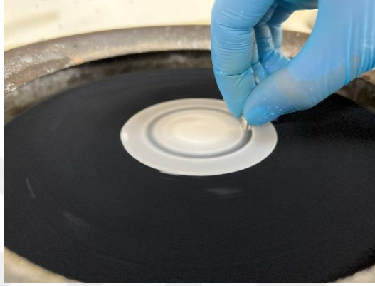
Resim 3.9 METKON FINOCUT hassas kesim cihazı ve METKON FORCIPOL 2V zımparalama ve parlatma cihazı ve parlatma prosesi.
