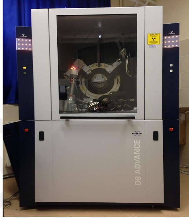
Resim 3.10 Bruker D8 Advance x-ışınları kırınım cihazı.
