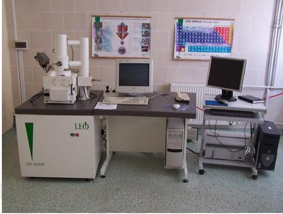
Resim 3.11 LEO 1430VP taramalı elektron mikroskobu.
