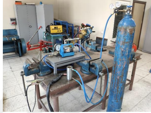
Resim 3.6 Mastır alaşımların ark ergitme yöntemiyle ters vakum döküm sistemi.
