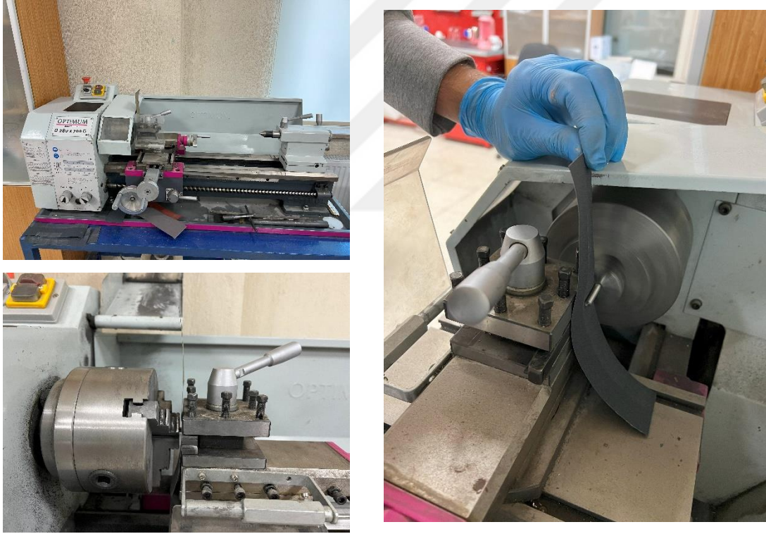
Resim 3.8 OPTIMUM D 280x700G torna tezgâhı ve alt, üst, yan yüzey zımparalama prosesi.
