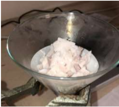
Resim 7.1. C 6 H 5 OH/HBF 4 mol oranı 2/1 ve sıcaklık 40 °C olduğunda oluşan kristaller
