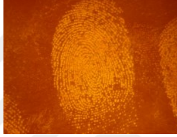
Şekil 2.8. DFO ile görünür hale getirilmiş bir parmak izi örneği.
