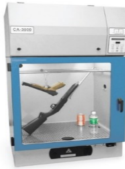
Şekil 2.6. Gözeneksiz yüzeylerde gizli parmak izlerinin görünür hale getirilmesi için uygulanan siyanoakrilat dumanlama yöntemi örneği.
