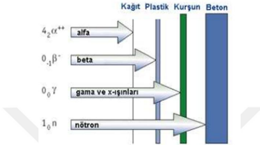
Şekil 25. Farklı Radyasyon Türlerine Göre Zırhlama Malzemeleri (Sürücü ve Subaşı, 2021).
