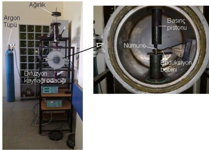
Şekil 3. 2 Difüzyon kaynak düzeneğinin şematik görüntüsü.
