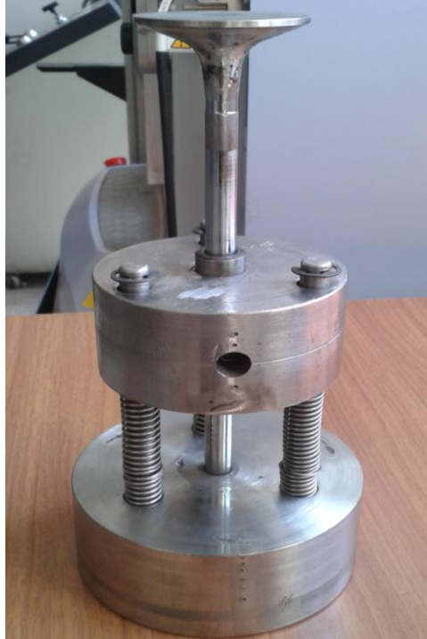
Şekil 3. 1 Tozların kompaktlandığı kalıp [30].
