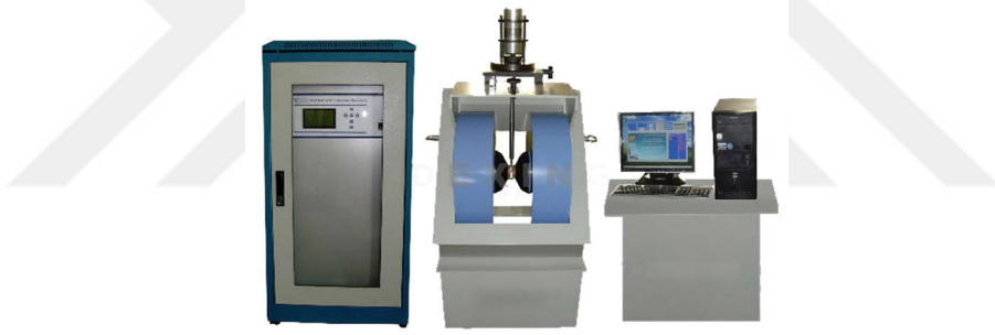
Şekil 15. VSM (titreşimli numune manyetometresi) analiz cihazı
