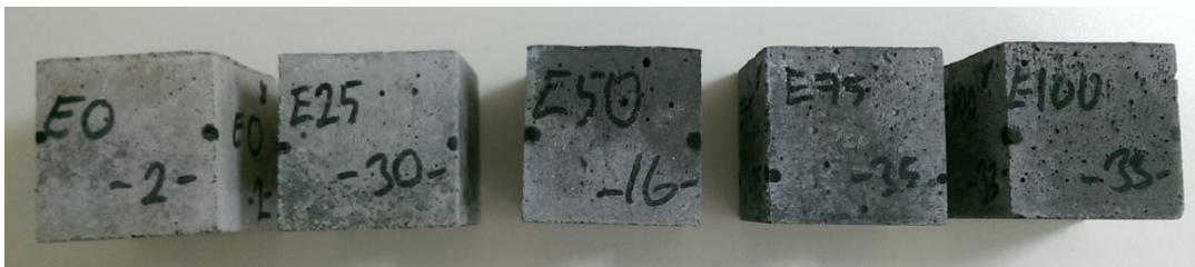
Şekil 4. 35. %5 MgCl_2 çözeltisinde 12 hafta bekletilen numunelerin görünüşleri
