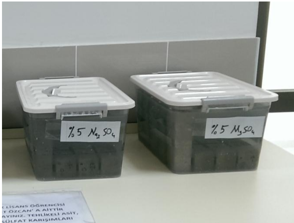
Şekil 3. 21. Numunelerin yerleştirildiği sülfat çözeltileri
