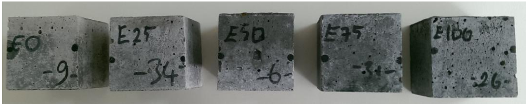
Şekil 4. 34. %5 NaCl çözeltisinde 12 hafta bekletilen numunelerin görünüşleri
