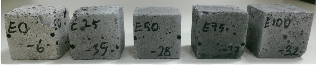
Şekil 4. 22. %5 H_3PO_4 çözeltisinde 12 hafta bekletilen numunelerin görünüşleri
