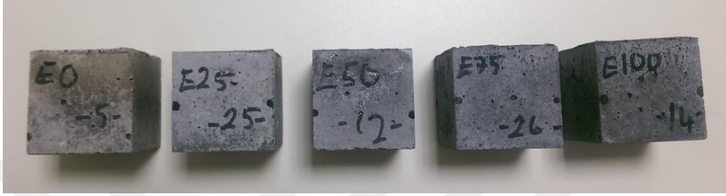
Şekil 4. 45. %5 Na_2SO_4 çözeltisinde 12 hafta bekletilen numunelerin görünümleri
