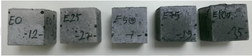
Şekil 4. 6. Kontrol numunelerin kür sürelerini tamamladıktan sonra 12 hafta sonundaki görünüşleri
