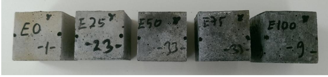
Şekil 4. 44. %5 MgSO_4 çözeltisinde 12 hafta bekletilen numunelerin görünümleri
