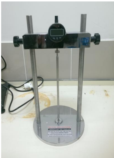
Şekil 3. 15. Boy değişimi ölçüm çerçevesi
