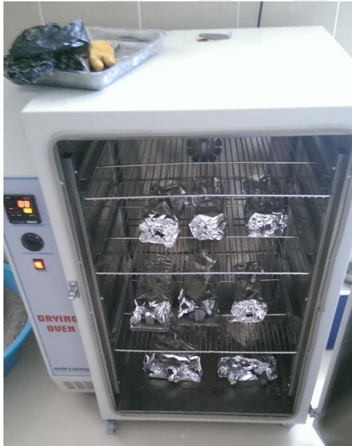
Şekil 3. 17. Kalıpların etüve konması
