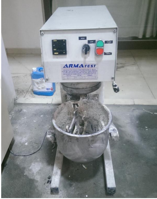
Şekil 3. 8. Beton karışım mikseri
