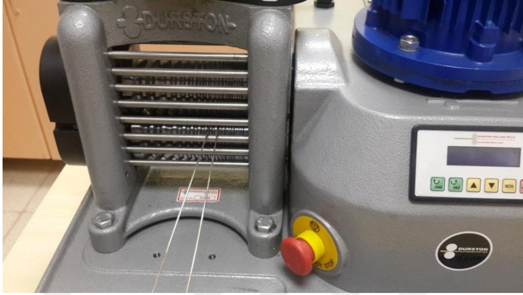
Şekil 3.7. İBTAM laboratuvarlarında bulunan roller tipi tel çekme sistemi.
