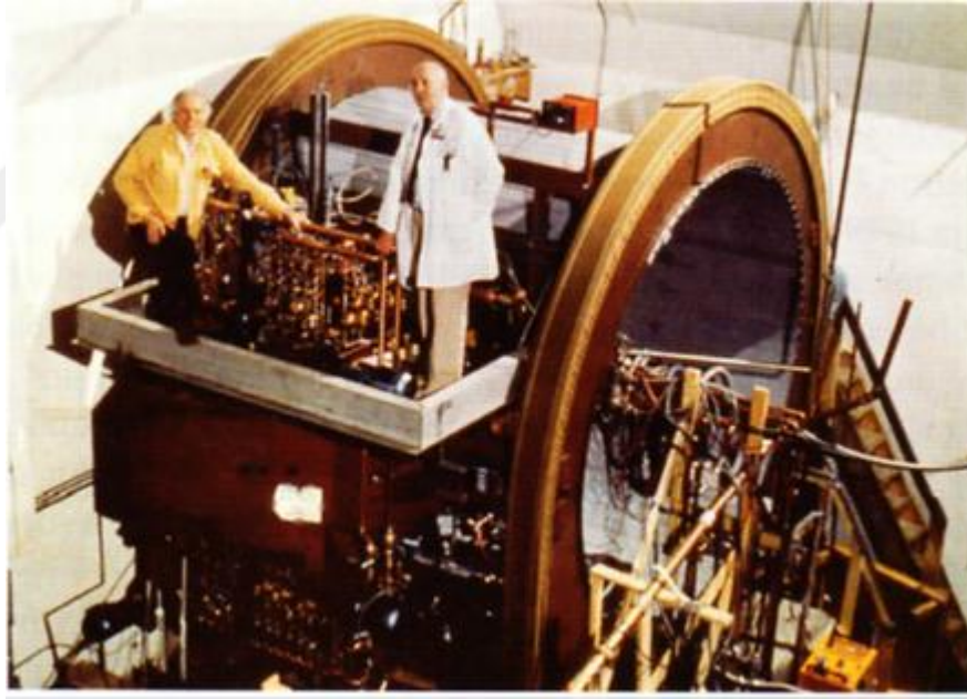
Şekil 2.43. K100 süperiletken siklatron [213].
