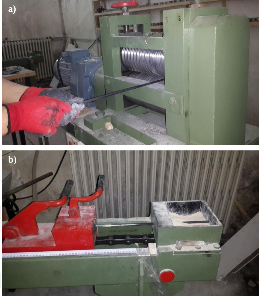
Şekil 3.8. Bolu’ da Abant İzzet Baysal Üniversitesi Fizik Bölümü laboratuvarlarında bulunana) uç sivriltme sistemi, b) “die-çekme” tipi tel çekme sistemi.
