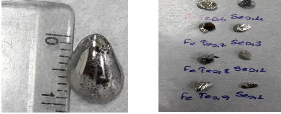
Şekil 3.4. Elde edilen FeTe_{1-x}Se_x ( x=0.1-0.4 ) tek kristaller.
