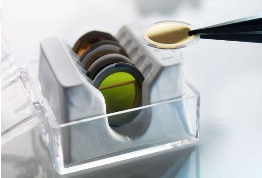
Şekil 2.8. QCM Sensörleri, daha sonra QCM kristal içerisindeki salınımların süresini ölçer. Biyosensör olarak kullanıldığında, QCM kristalin yüzeyindeki kütle değişimlerinden dolayı kristalin salınımlarındaki değişimleri ortaya çıkarmaktadır 29 .
