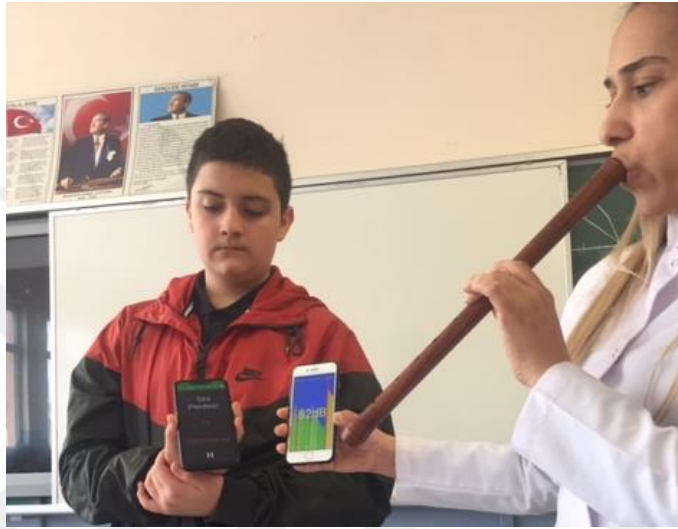
Şekil 3.6.19 Cep telefonu uygulaması ile ses şiddeti ölçümü
