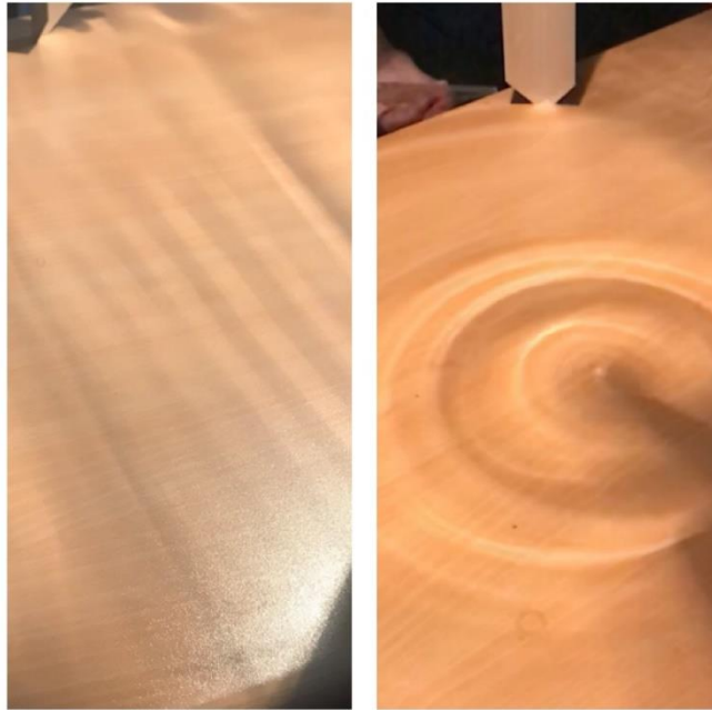
Şekil 3.6.14 Sırasıyla doğrusal ve dairesel su dalgasının dalga leğeninde üstten görünümü
