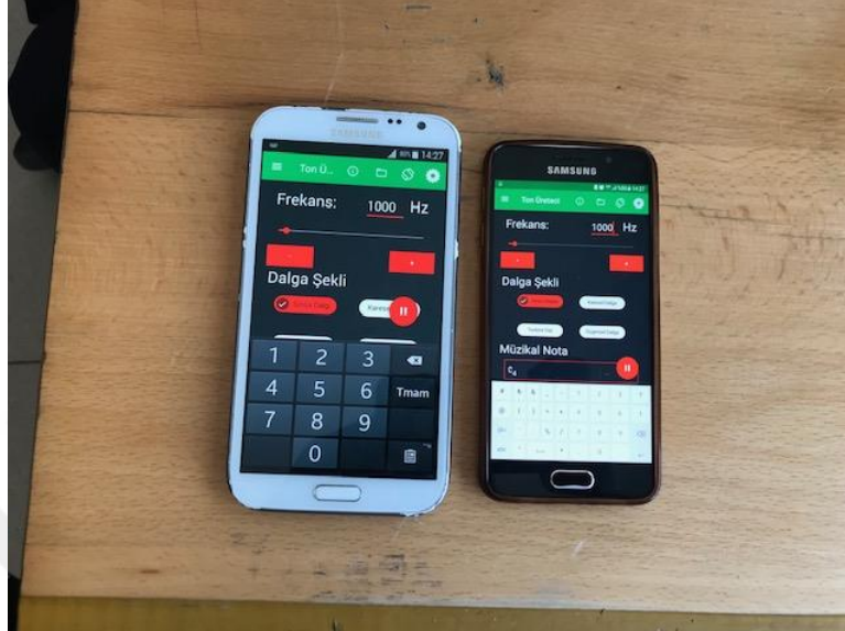
Şekil 3.6.20 Cep telefonu uygulaması ile iki cep telefonunda aynı frekansta ses üreterek rezonans olayını gösterme
