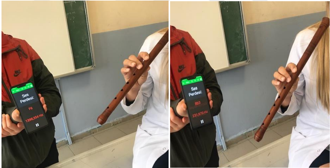
Şekil 3.6.18. Cep telefonu uygulaması ile tiz ses frekans gösterimi
